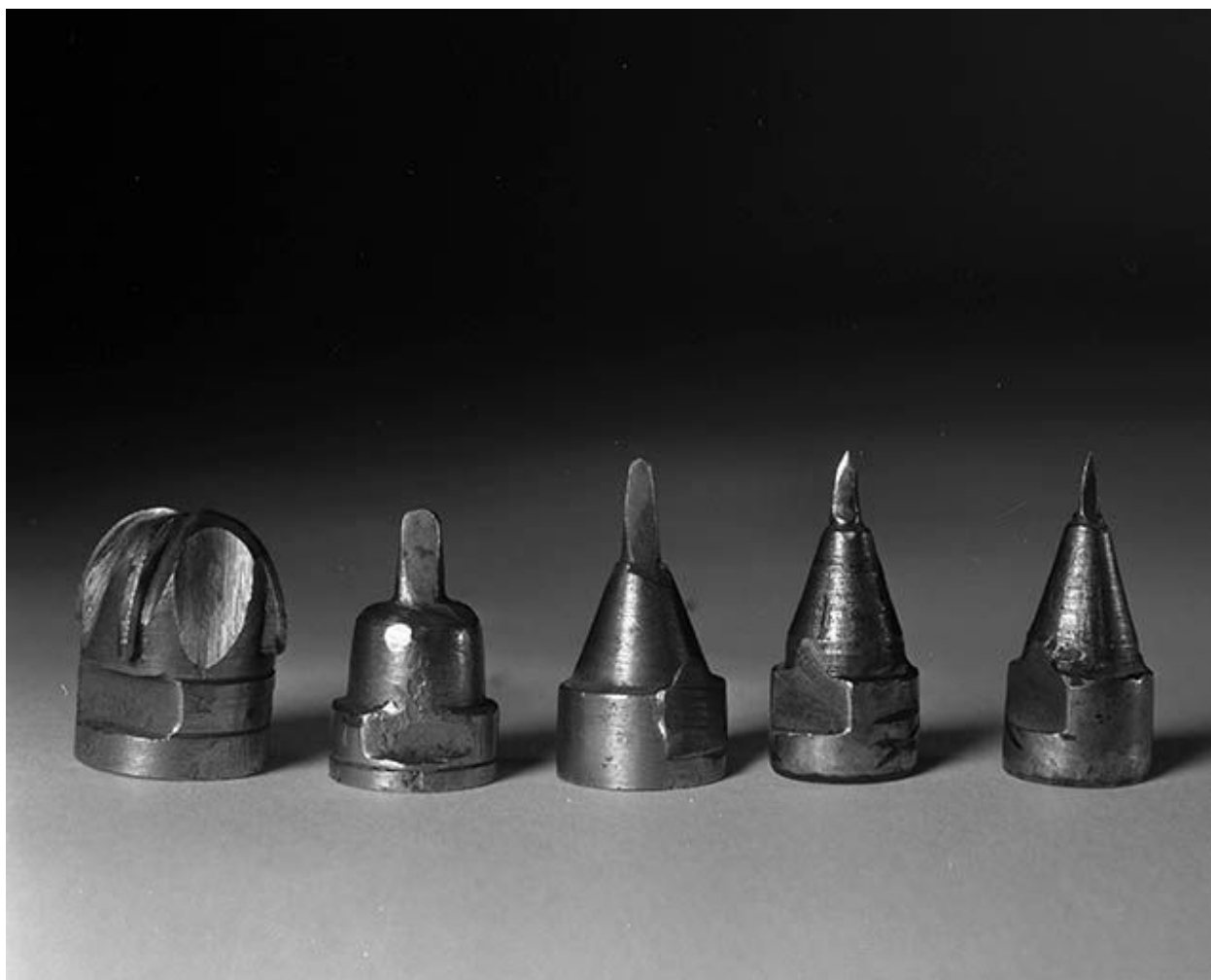
Jeu des fraises utilisées avec la machine.
