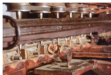
Face arrière : ébauchon sculpté et fraise de finition. Phot. Jérôme Mongreville IVR43_20003901194ZA
