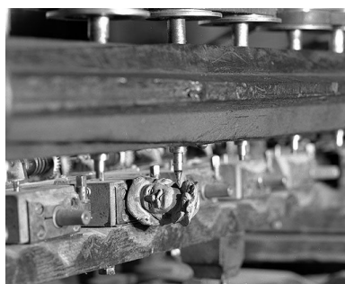
Face arrière : ébauchon sculpté et fraise de finition. Phot. Jérôme Mongreville IVR43_20003901193X
