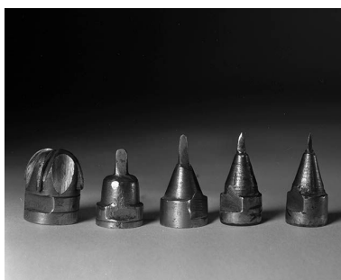
Jeu des fraises utilisées avec la machine. Phot. Jérôme Mongreville IVR43_20003900944X
