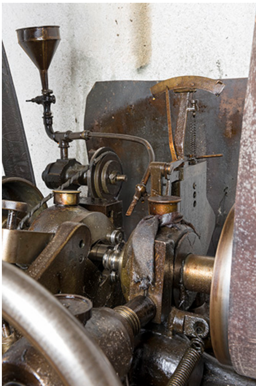
Partie travaillante (sous le tuyau d'amenée d'huile).
