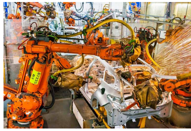
Usine Peugeot de Sochaux-Montbéliard. Robot de soudage. Phot. Jérôme Mongreville IVR43_20132502757NUC4A
