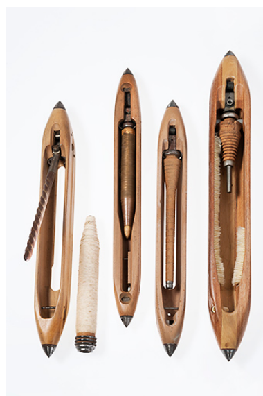
Navettes de métiers à tisser fabriquées à l'usine Ferrand de Grand-Charmont. Phot. Jérôme Mongreville IVR43_20132502810NUC4A
