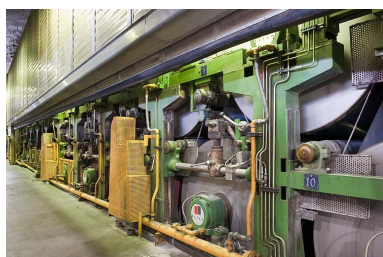
Machine à papier. Vue d'ensemble de la partie séchage. Phot. Jérôme Mongreville IVR43_20122500984NUC4A
