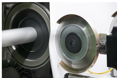
Détail d'une tête de découpage. Phot. Jérôme Mongreville IVR43_20122500989NUC4A
