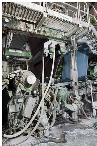
Machine à papier. Vue rapprochée de la tête de machine (pressage et égouttage). Phot. Jérôme Mongreville IVR43_20122500980NUC4A
