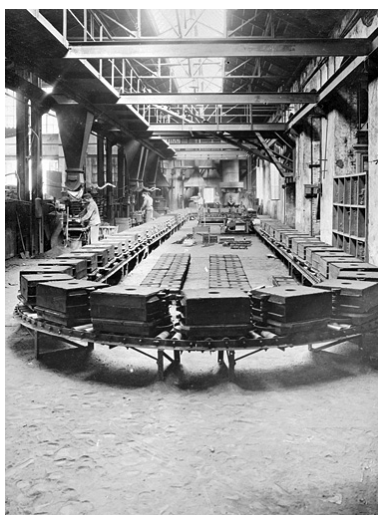
Fonderie : carrousel pour le moulage des grilles de résistance. Phot. Jérôme Mongreville IVR43_20029000180X
