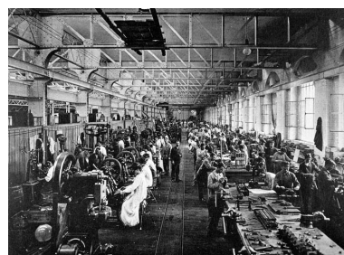
Atelier des petites dynamos - Préparation des enroulements, rhéostats et porte-balais. Phot. Jérôme Mongreville, Autr. Ernest (photographe) Mésière IVR43_20019000202X
