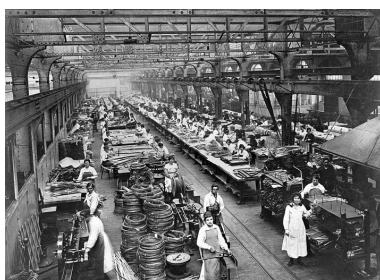
Bobinage dans l'atelier des grandes dynamos. Phot. Jérôme Mongreville IVR43_20029000197X
