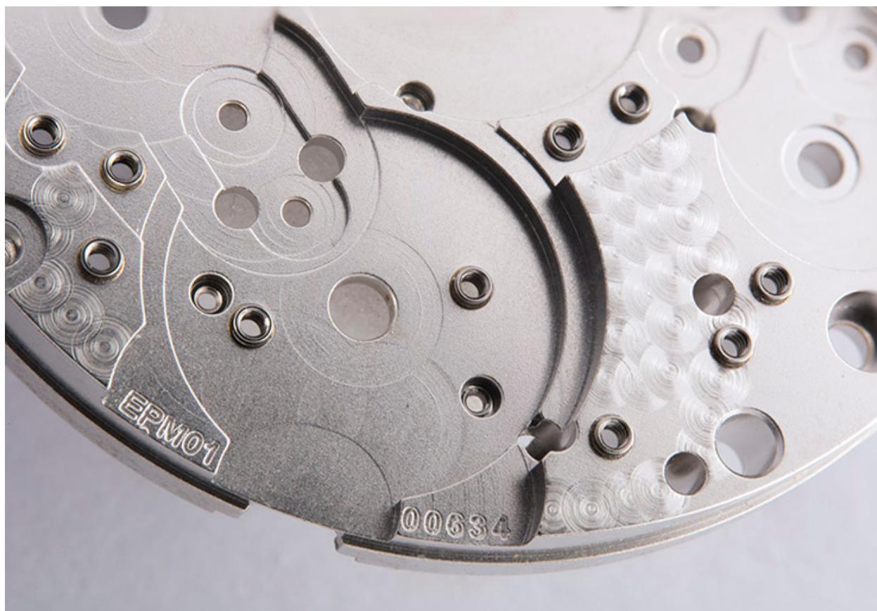
Platine, face côté fond : emplacement destiné au balancier-spiral.
