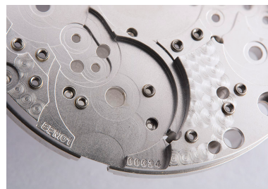
Platine, face côté fond : emplacement destiné au balancier-spiral. Phot. Sonia Dourlot IVR43_20182501180NUC4A
