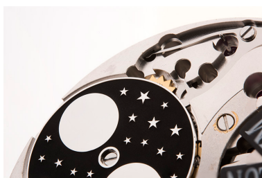
Face côté cadran : détail du disque des phases de lune. Phot. Sonia Dourlot IVR43_20182501186NUC4A
