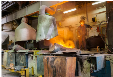
Prélèvement dans un four à induction. Phot. Jérôme Mongreville IVR43_20132500951NUC4A
