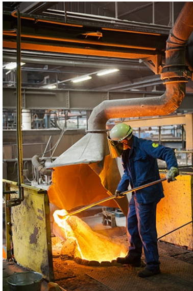
Prélèvement de matière en fusion dans un four à induction (4). Phot. Jérôme Mongreville IVR43_20132500961NUC4A
