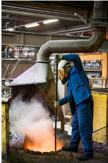
Prélèvement de matière en fusion dans un four à induction (1). Phot. Jérôme Mongreville IVR43_20132500960NUC4A
