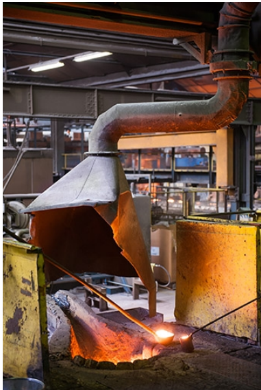
Prélèvement de matière en fusion dans un four à induction (3). Phot. Jérôme Mongreville IVR43_20132500959NUC4A
