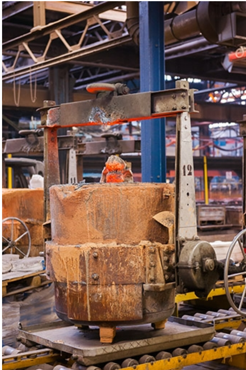
Poche de coulée avant réfection.
