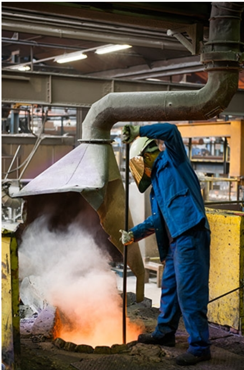
Prélèvement de matière en fusion dans un four à induction (1).
