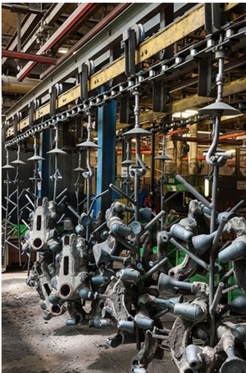
Pièces au dessablage (grenailleuse).
