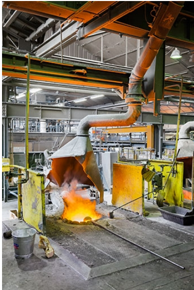
Four à induction en service. Phot. Jérôme Mongreville IVR43_20132500957NUC4A
