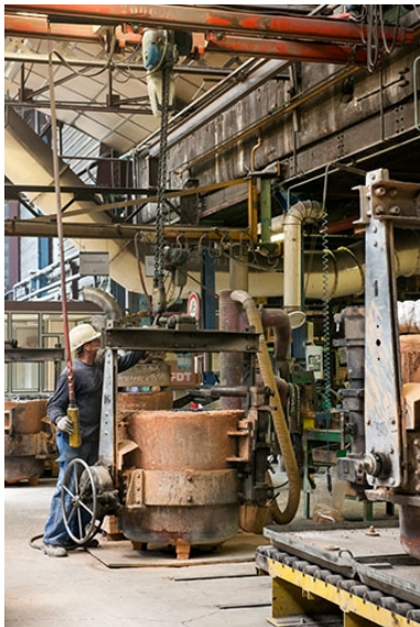
Manutention d'une poche de coulée. Phot. Jérôme Mongreville IVR43_20132500950NUC4A
