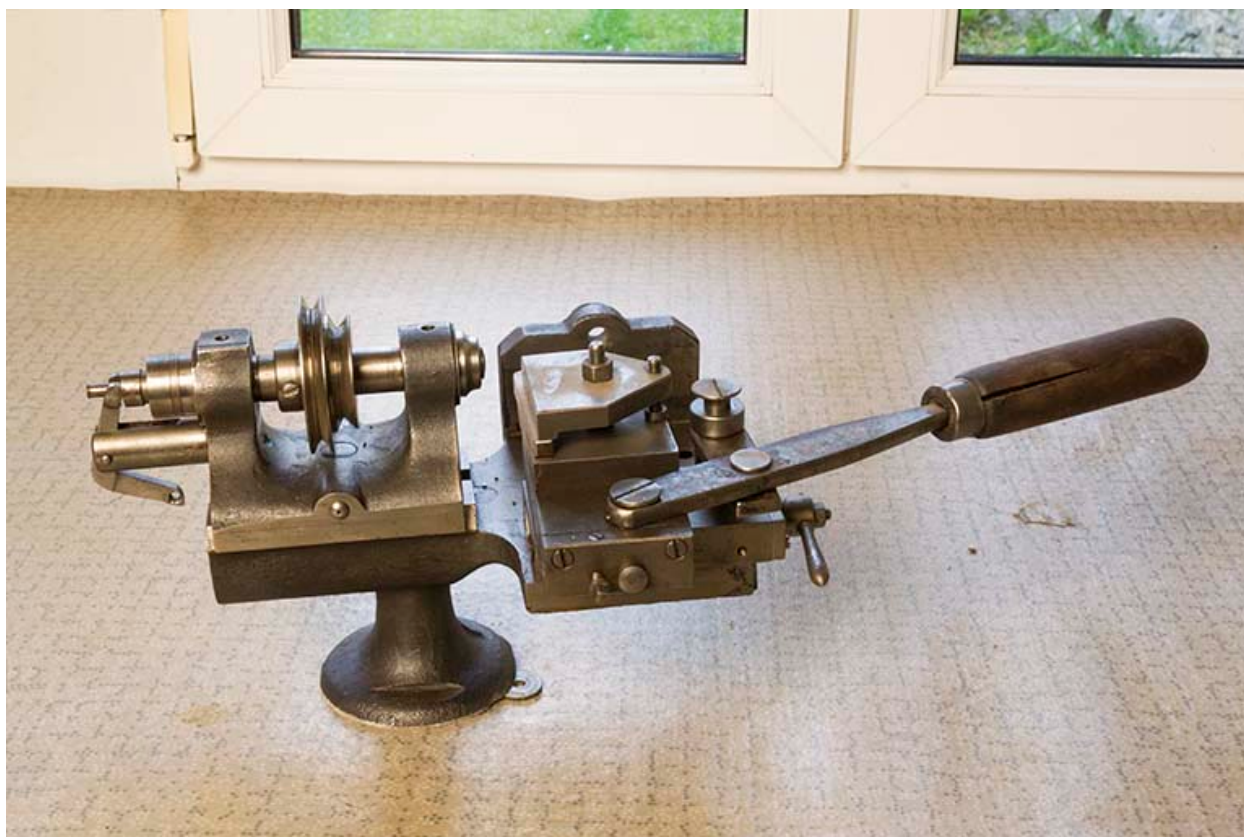
L'atelier (1912) d'un petit fabricant de machines pour les horlogers : Adelin Berçot puis Maurice Roch, au 13 rue Sous Monjoie. Machine à tamponner (insérer les tampons dans l'écorce du cylindre) des années 1910.
