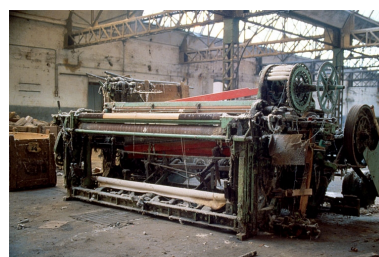
Face avant du métier à tisser. Les cannettes, dans le barillet surmontant le métier, étaient fabriquées à l'usine. Phot. Laurent Poupard IVR43_19883900161ZA
