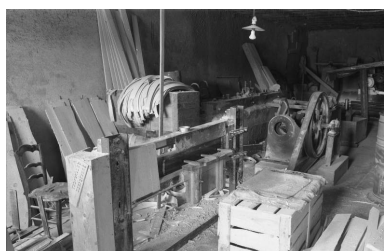
Vue d'ensemble de la targeuse, du côté d'application du bois. Rabot à gauche, système moteur à droite. Phot. Laurent Poupard IVR43_19913901614Z
