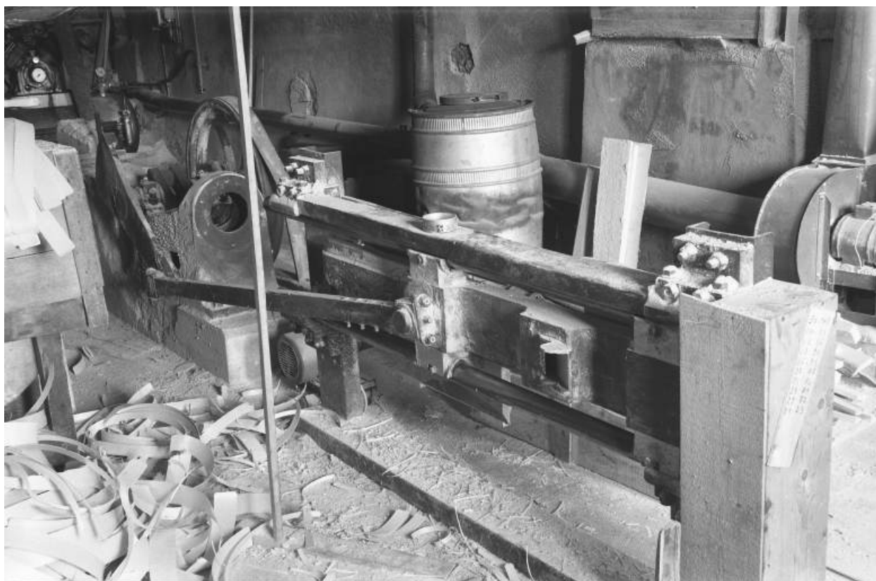
Vue d'ensemble de la targeuse, du côté de sortie des lanières de bois. Système moteur à gauche, rabot à droite.
