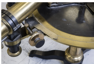
Détail des graduations et du vernier. Phot. Yves Sancey IVR43_20072500610NUCA
