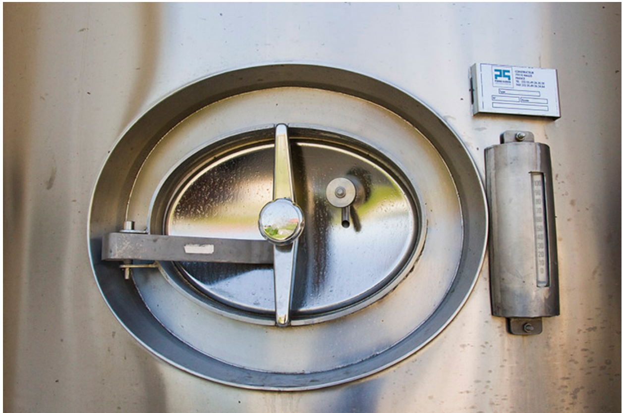
Porte d'une cuve de stockage.
