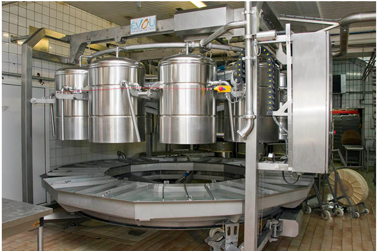
Groupe de soutirage.
