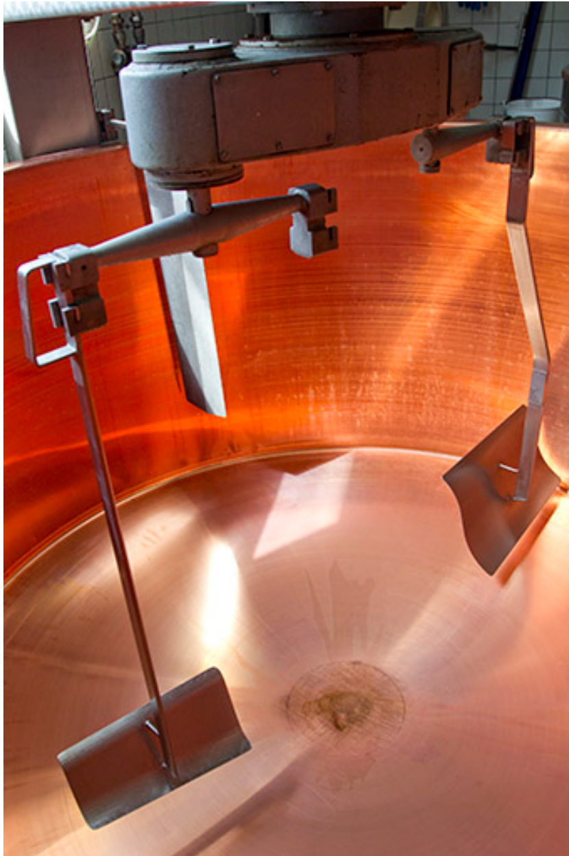
Cuve de fabrication : outils de brassage.
