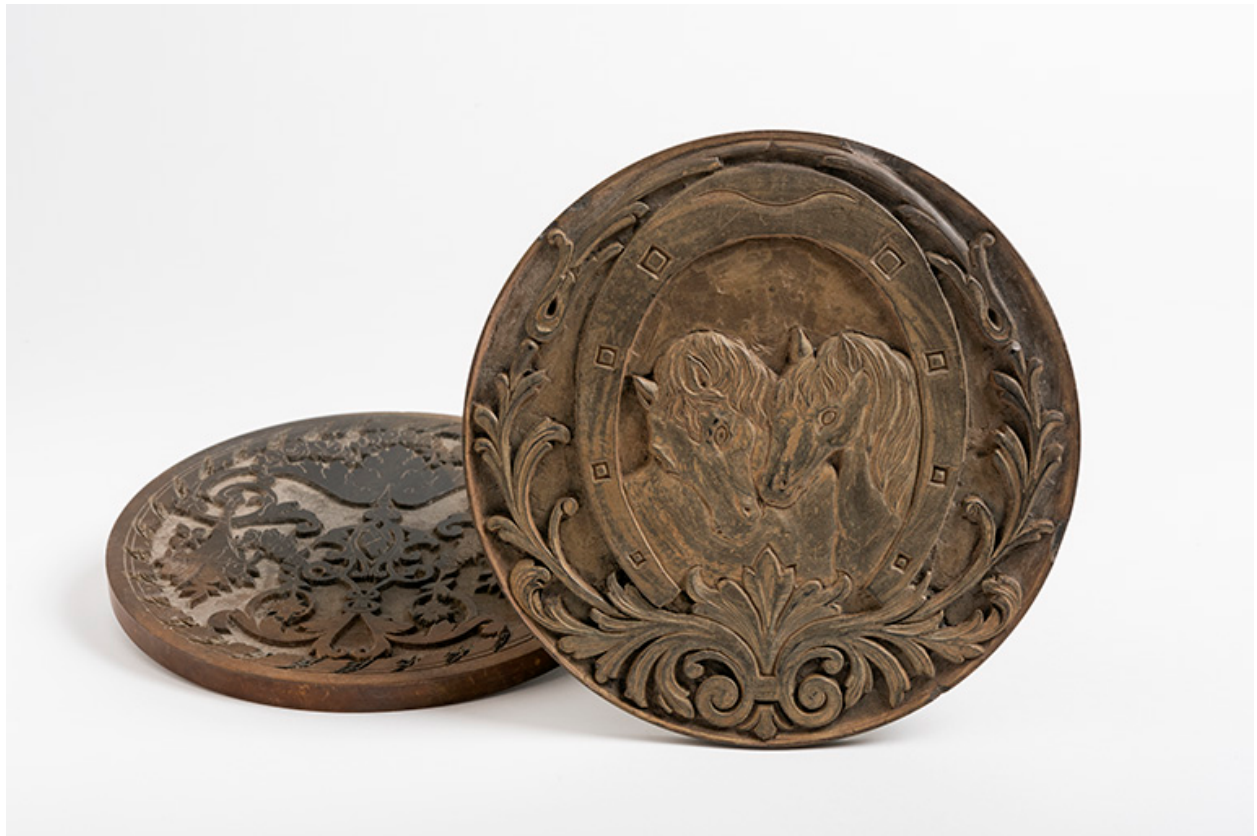
"Patronnes" pour machine à guillocher. (Collection musée de l'Horlogerie, Morteau).
