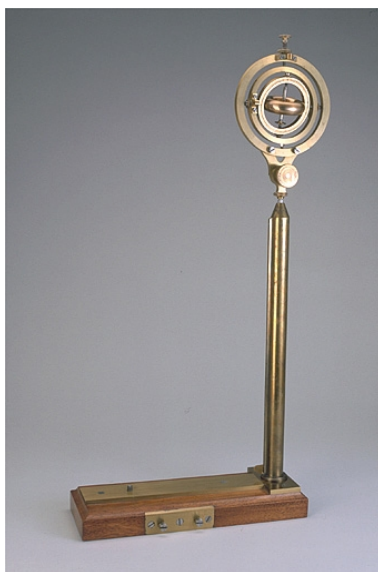
Montage : appareil de Bohnenberger. Phot. Jérôme Mongreville IVR43_20032500977XA
