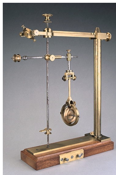
Montage : tourniquet alternatif à tension de M. Gruey. Phot. Jérôme Mongreville IVR43_20032500987XA
