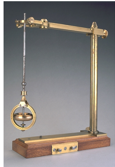
Montage : pendule polygonal de M. Gruey. Phot. Jérôme Mongreville IVR43_20032500972XA
