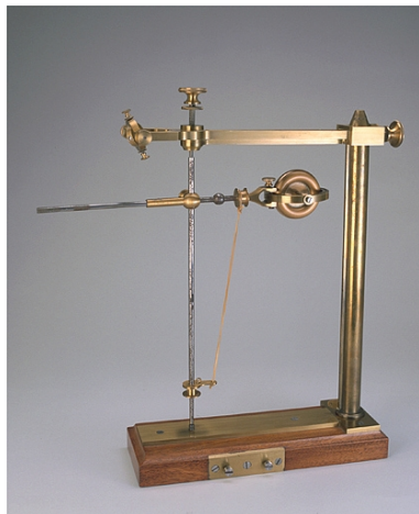
Montage : tourniquet alternatif à tension de M. Gruey. Phot. Jérôme Mongreville IVR43_20032500985XA
