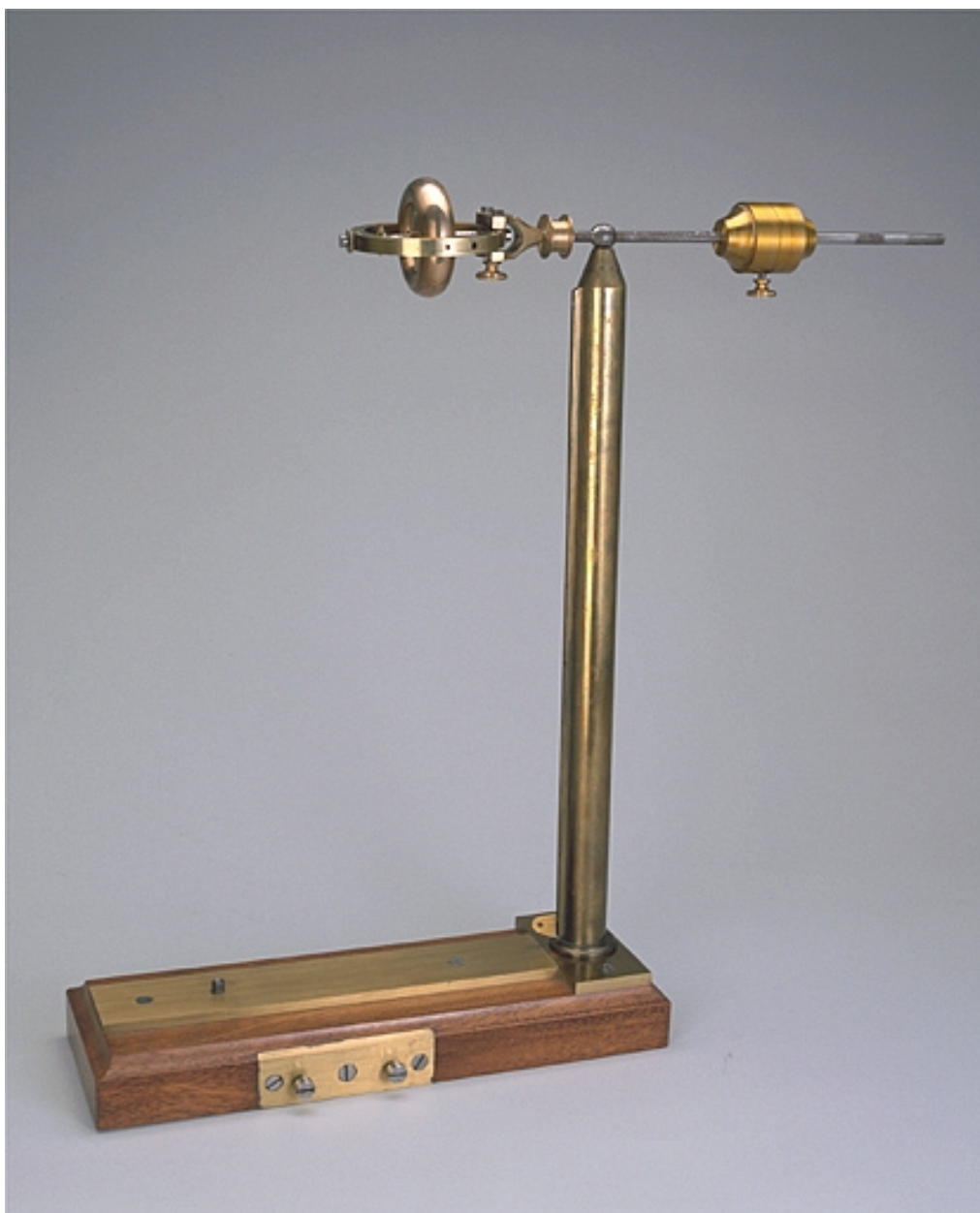
Montage : balance de Fessel et Plucker.
