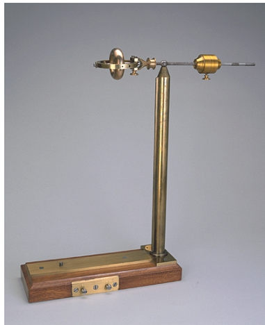
Montage : balance de Fessel et Plucker. Phot. Jérôme Mongreville IVR43_20032500983XA
