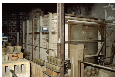
Four au fuel à flamme renversée (10). Phot. Laurent Poupard IVR43_19883900350ZA
