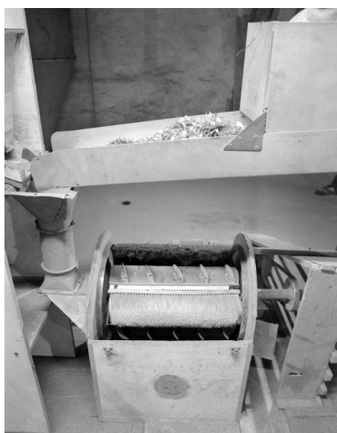
Vue plongeante. Le démontage de la paroi supérieure laisse apparaître les brosses (fibres végétales). Phot. Jérôme Mongreville IVR43_19973900315X
