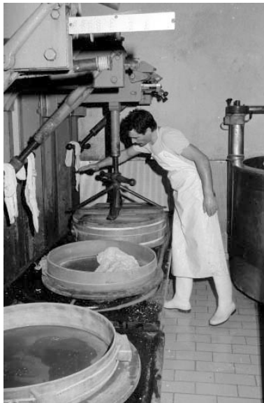
Fabrication du comté : mise sous presse. Phot. Laurent Poupard IVR43_19903900412Z
