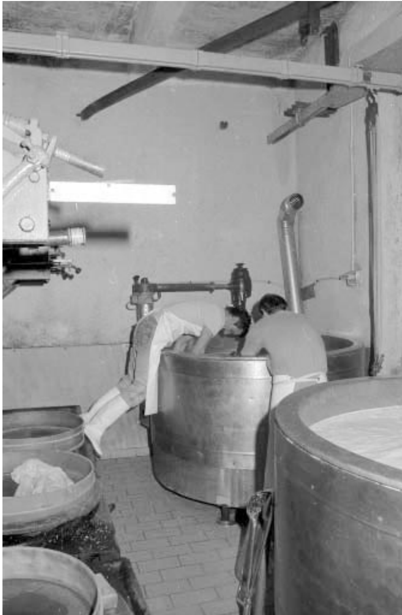
Fabrication du comté : ramassage du caillé dans la toile.
