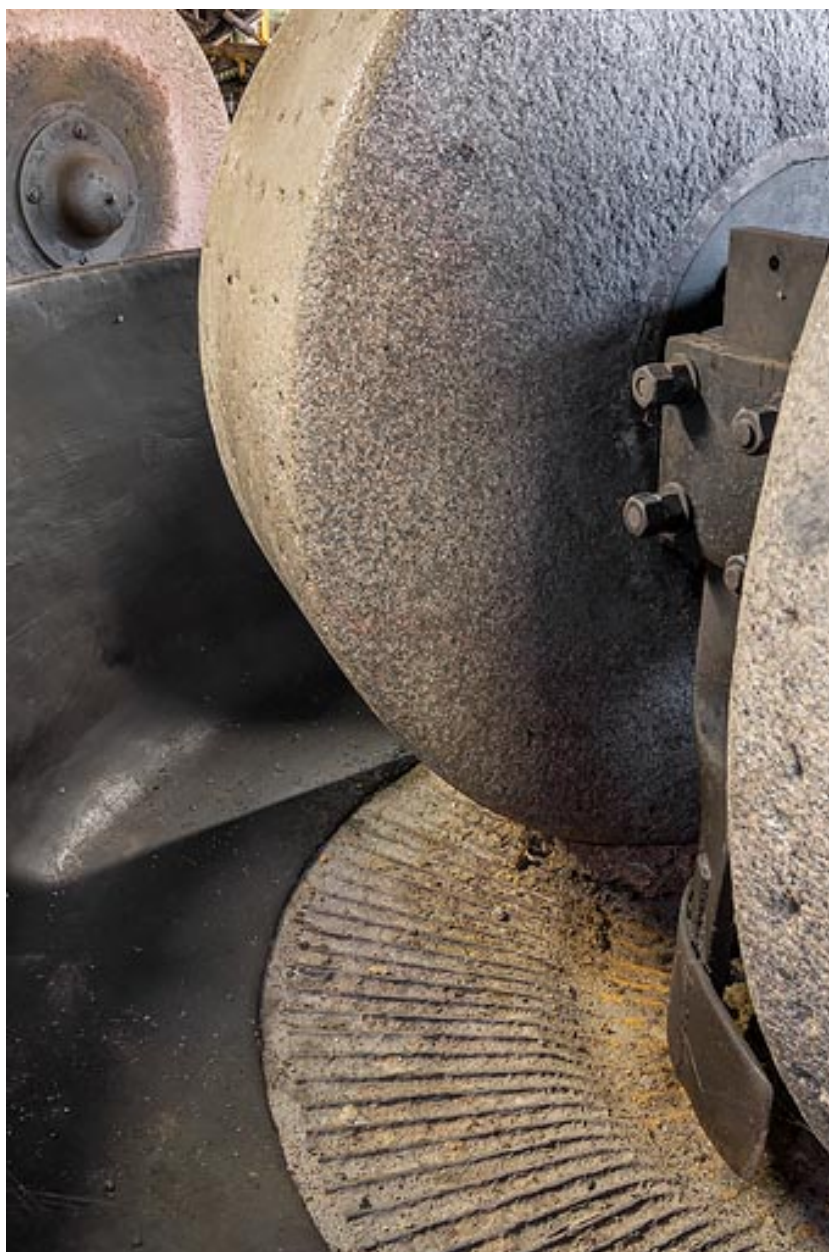
Défibreuse : détail des meules.
