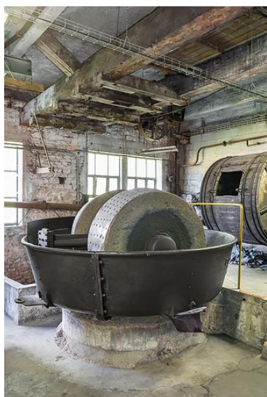
Défibreuse Lamort (cadrage vertical). Phot. Pierre-Marie Barbe-Richaud IVR46_20203900100NUC4A
