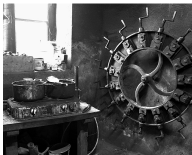
Atelier de fabrication des tuyaux en corne. Grillée pour en «tirer le nerf», la corne est redressée, tournée pour obtenir le tuyau, percée puis cintrée. Phot. Jérôme Mongreville IVR43_19923900506X
