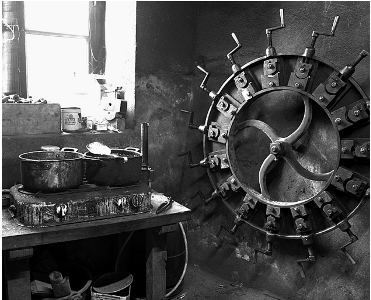
Atelier de fabrication des tuyaux en corne. Grillée pour en «tirer le nerf», la corne est redressée, tournée pour obtenir le tuyau, percée puis cintrée.
