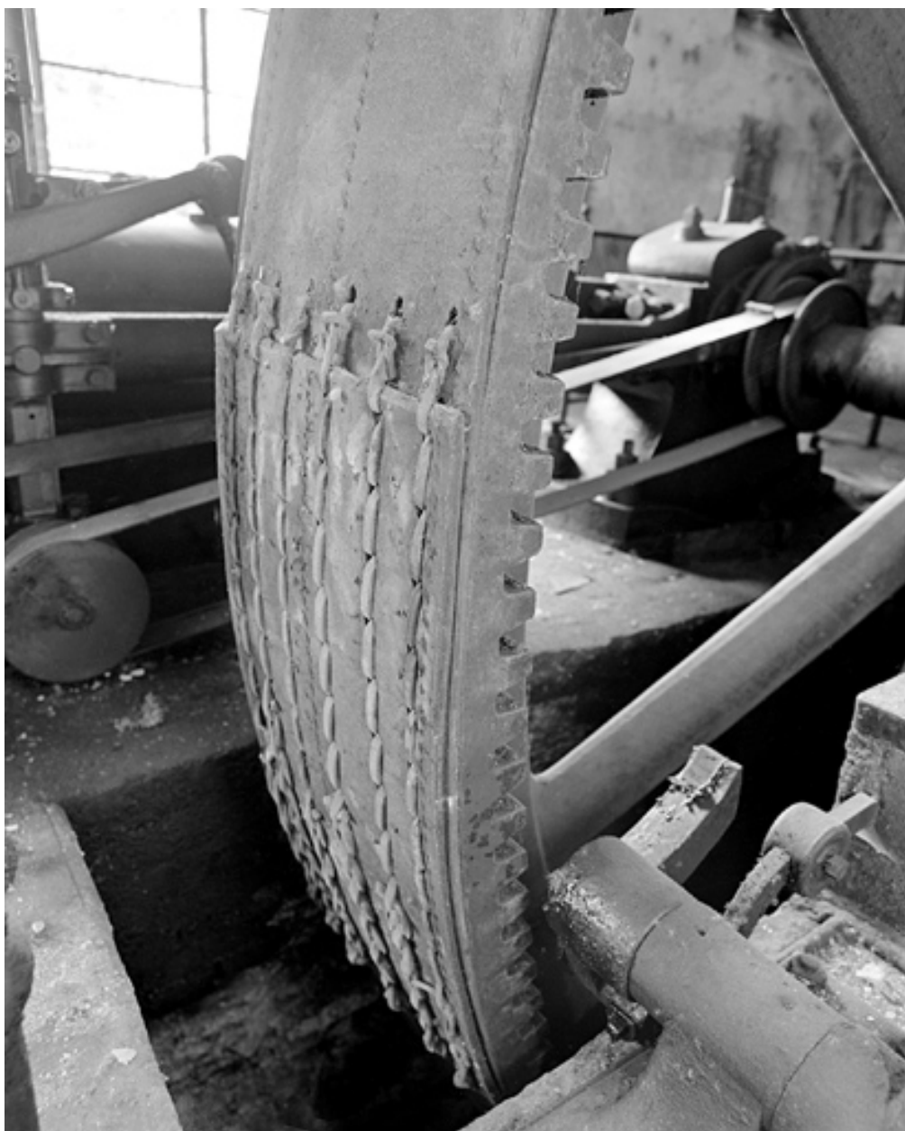
Détail du volant de transmission et de la courroie en cuir.
