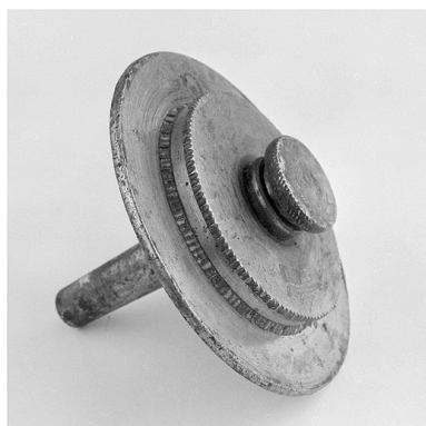
Détail d'un outil de coupe, montrant de profil les trois disques qui chanfreinent. Phot. Jérôme Mongreville IVR43_20022500945X
