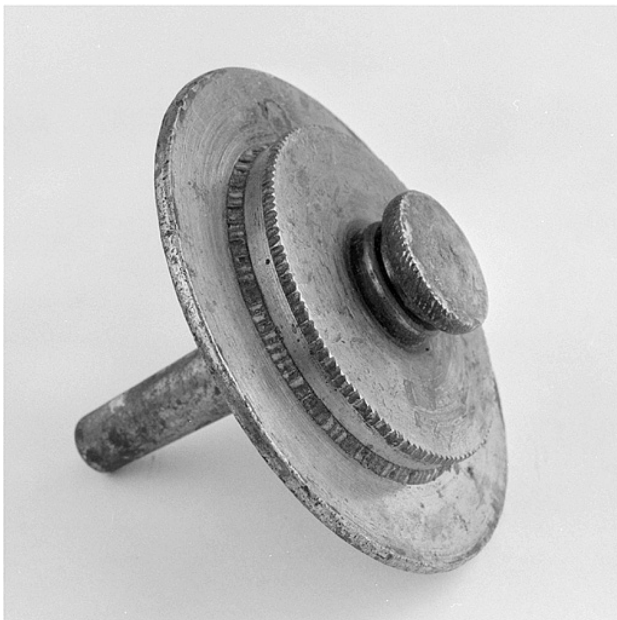
Détail d'un outil de coupe, montrant de profil les trois disques qui chanfreinent.
