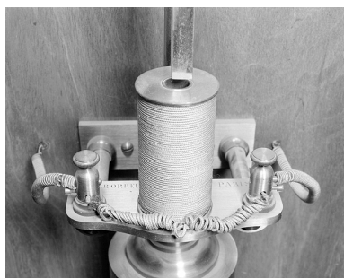
Le mécanisme de remise à l'heure Borrel. Phot. Jérôme Mongreville IVR43_20032501029X
