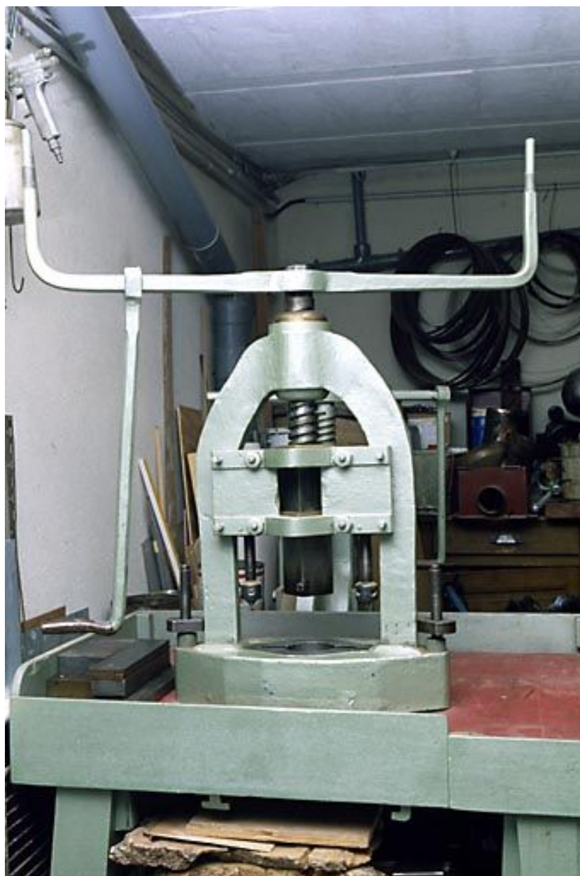
Machine à découper par poinçon ; machine à emboutir ; machine à estamper.
