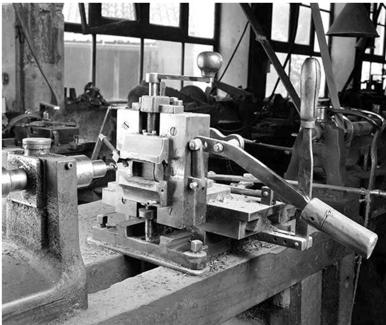
Machine à fraiser dite machine à renfoncer.
