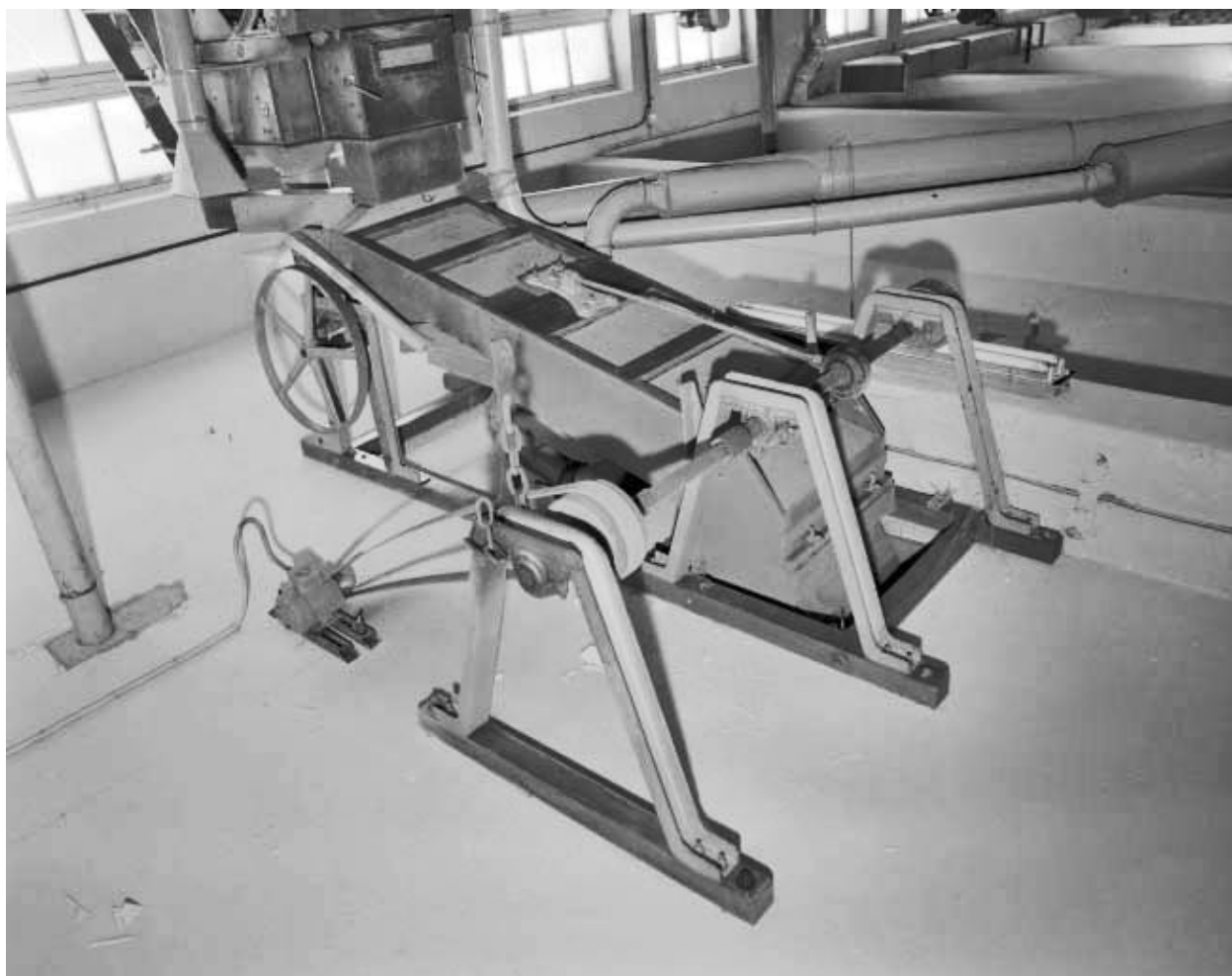
Trémie d'alimentation et distributeur vibrant.
