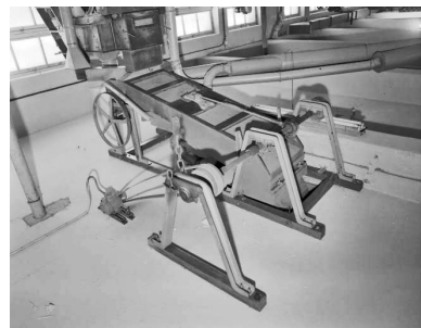
Trémie d'alimentation et distributeur vibrant. Phot. Jérôme Mongreville IVR43_19973900311X
