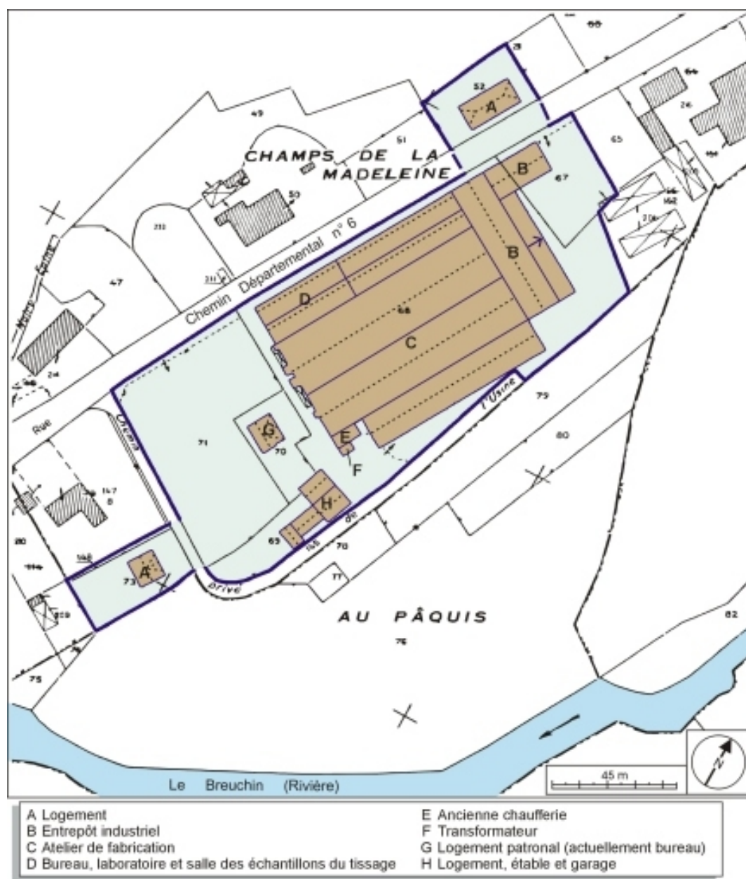
Plan-masse et de situation. Extrait du plan cadastral numérisé, 2005, section AC, 1:1000 réduit à 1:1500.
