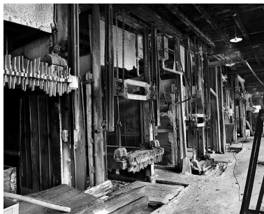
Vue d'ensemble des châssis multilames. Phot. Yves Sancey IVR43_19933900258X
