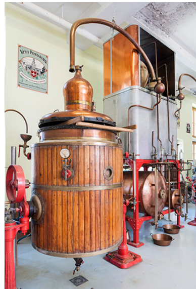
Alambic Egrot et Grange (1000 litres). Phot. Jérôme Mongreville IVR43_20162500407NUC4A
