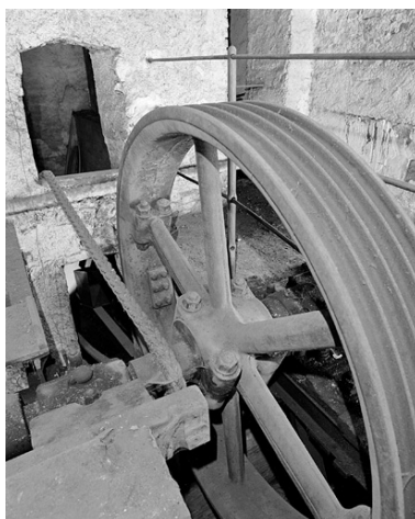
Détail de la roue de transmission de la machine à vapeur. Les gorges de la roue accueillait des câbles en chanvre de section carrée (l'un d'eux est visible contre l'axe de la roue).
