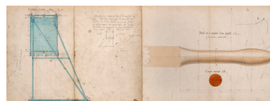
Construction du barrage mobile et de la seconde porte de garde de Saint- Albin - Fermettes et aiguilles (1876). Phot. Jérôme Mongreville, Autr. Gustave Bouvaist IVR43_20207000068NUC4A
