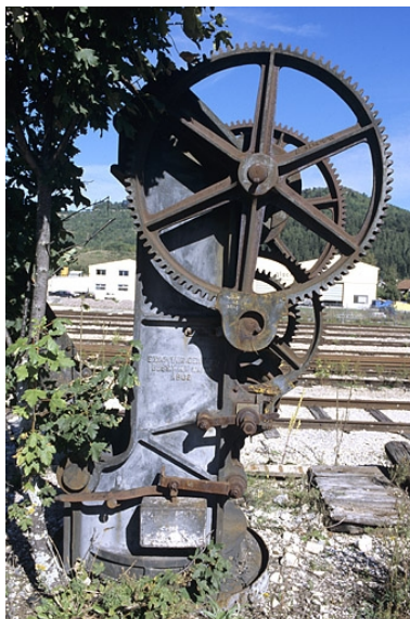
Arbre vertical et système de treuil. Phot. Yves Sancey IVR43_20043900163ZA
