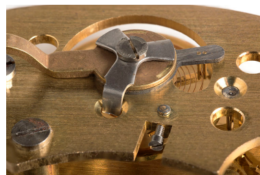
Système de réglage de l'avance/retard : raquette permettant de modifier la longueur active du spiral. Phot. Sonia Dourlot IVR43_20152502578NUC4A
