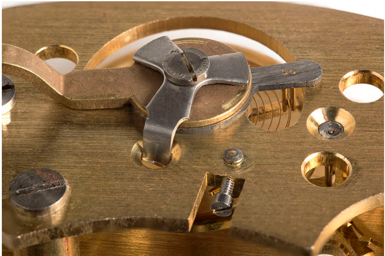
Système de réglage de l'avance/retard : raquette permettant de modifier la longueur active du spiral.
