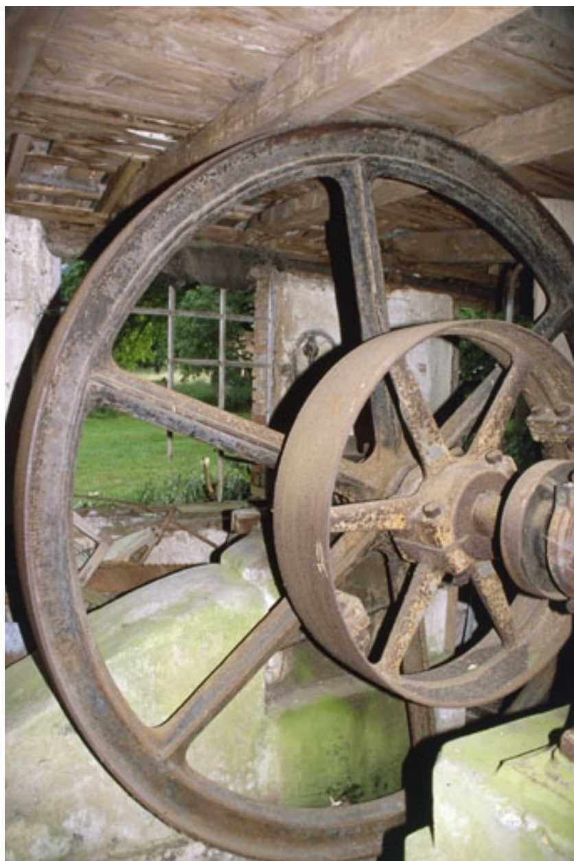
Machine à vapeur : détail du volant de transmission.
