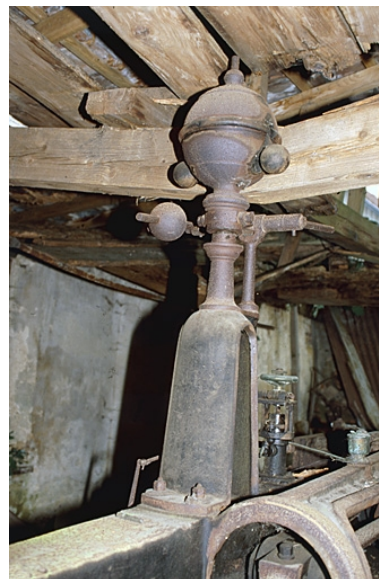
Machine à vapeur : détail du régulateur à boules. L'entrait de la charpente, brisé, repose sur le régulateur. Phot. Yves Sancey IVR43_20009000378ZA
