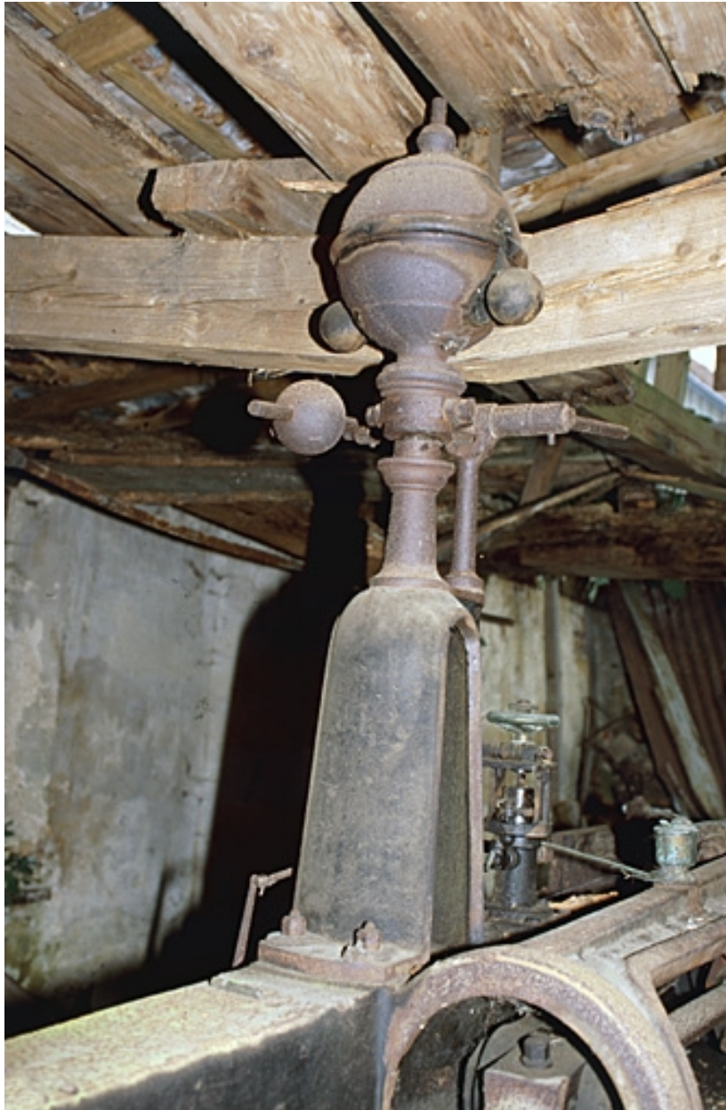
Machine à vapeur : détail du régulateur à boules. L'entrait de la charpente, brisé, repose sur le régulateur.
