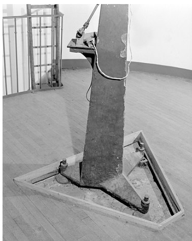
Pied et vis calantes. Le pied repose sur un pilier en béton, situé à l'étage inférieur. Phot. Yves Sancey IVR43_20032501138X
