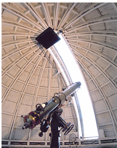
L'intérieur du dôme et la lunette, vue du côté volant de rotation et partie oculaire. Phot. Yves Sancey IVR43_20032501133XA
