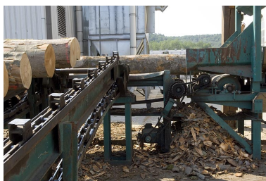
Train d'écorçage des grumes. Phot. Jérôme Mongreville IVR43_20067000474NUCA
