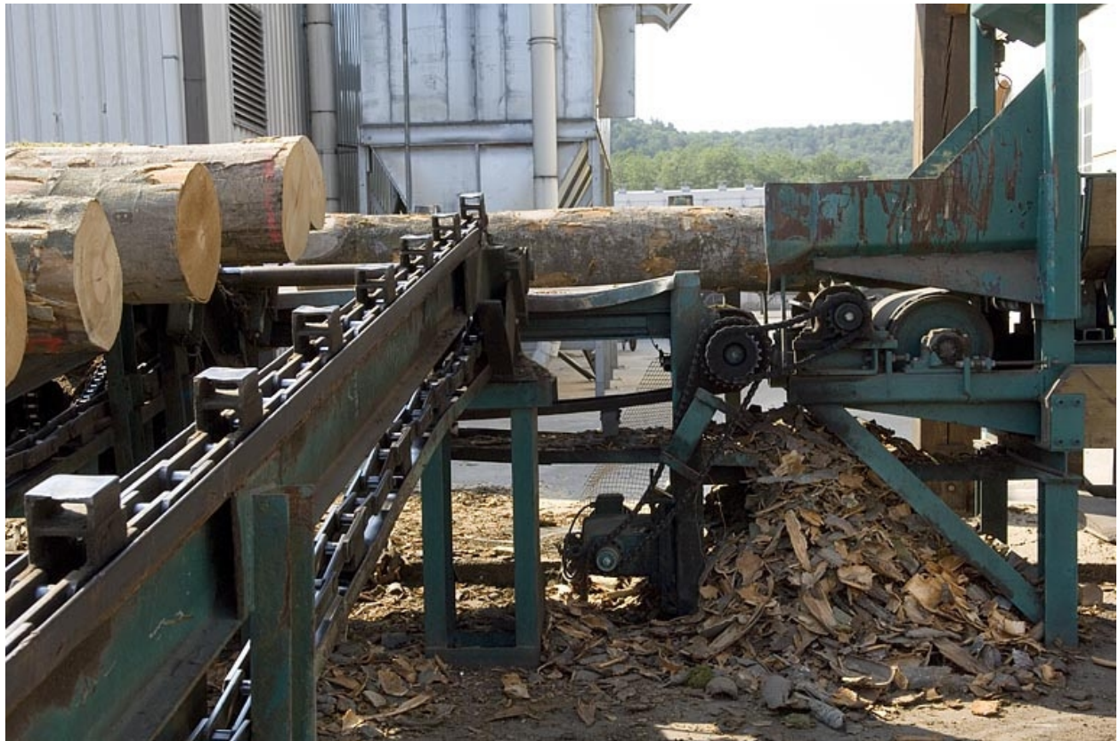
Train d'écorçage des grumes.
