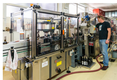
Unité de conditionnement (embouteillage, pose du bouchon et de la capsule, étiquetage). Phot. Jérôme Mongreville
