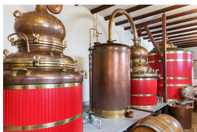
Alambics. Vue rapprochée des cucurbites et réfrigérants.
