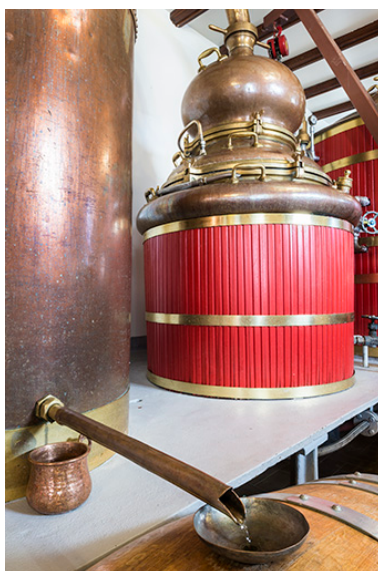
Distillation en cours. Ecoulement du distillat du réfrigérant. Phot. Jérôme Mongreville IVR43_20162501133NUC4A
