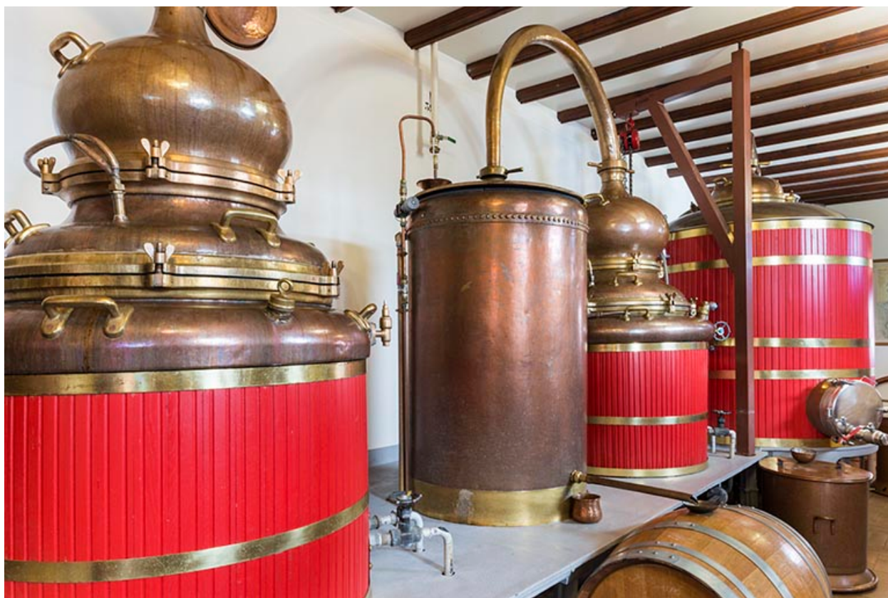
Alambics. Vue rapprochée des cucurbites et réfrigérants.
