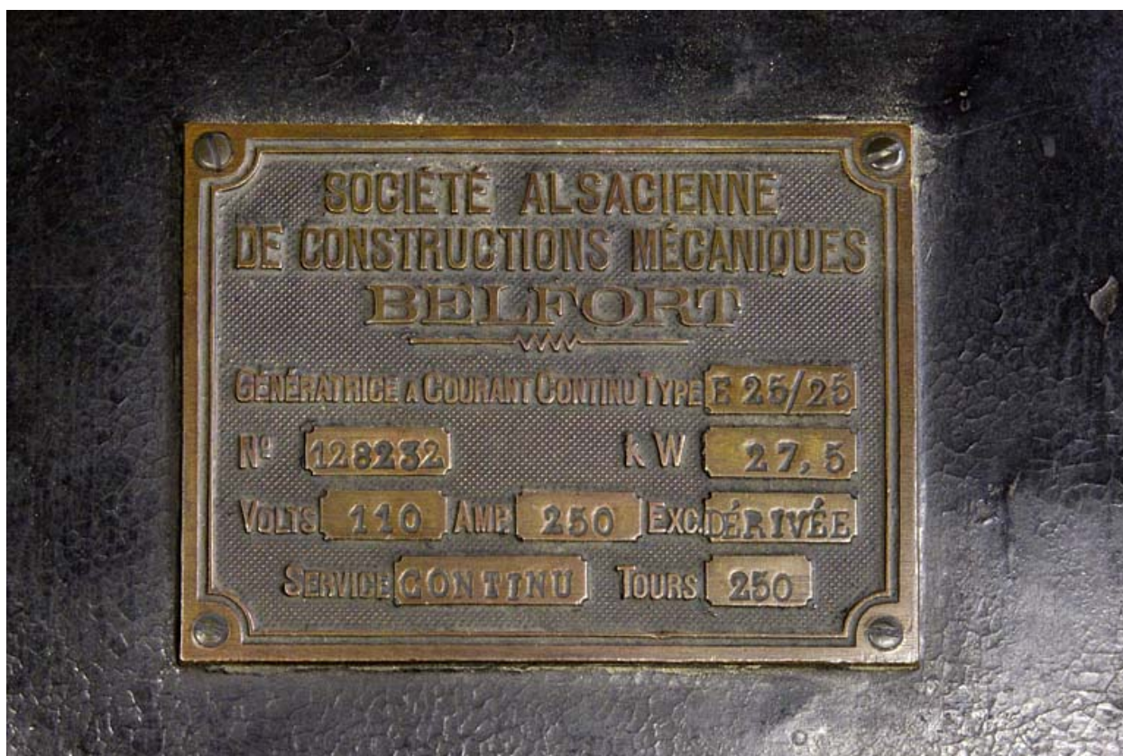
Centrale : plaque signalétique de l'excitatrice.
