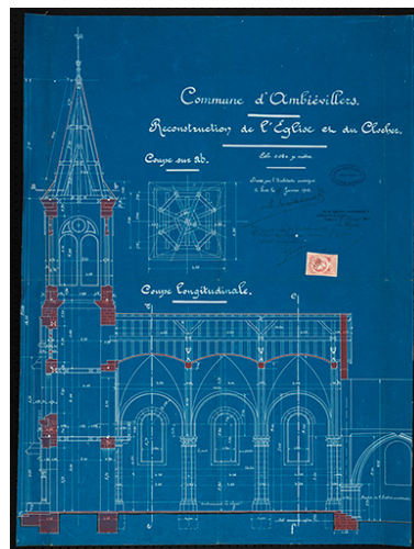
Plan présentant le projet de reconstruction du clocher et de la nef, coupe longitudinale. Phot. Sonia Dourlot, Autr. Broutchoux IVR43_20167000004NUC4A
