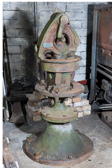
Machine Vernet (Dijon) à poinçonner et à découper. Phot. Jérôme Mongreville IVR43_20152501857NUC4A
