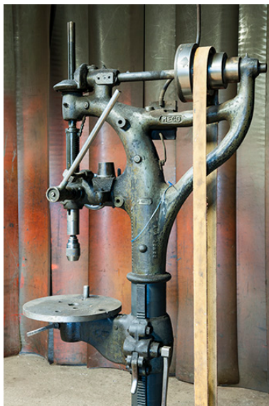
Détail de la perceuse à colonne. Phot. Jérôme Mongreville IVR43_20152501859NUC4A
