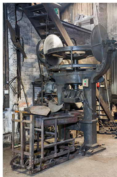
Balancier à friction et sa desserte. Phot. Jérôme Mongreville IVR43_20152501849NUC4A
