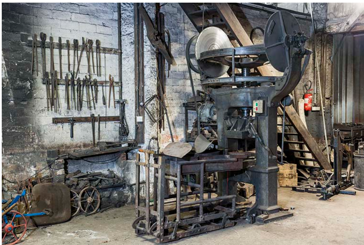
Balancier à friction (emboutissage des socs).
