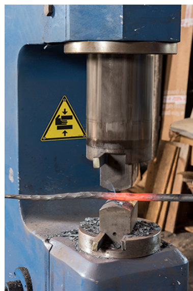
Martelage d'une barre au marteau- pilon pneumatique Glaser. Phot. Sonia Dourlot IVR43_20172501589NUC4A
