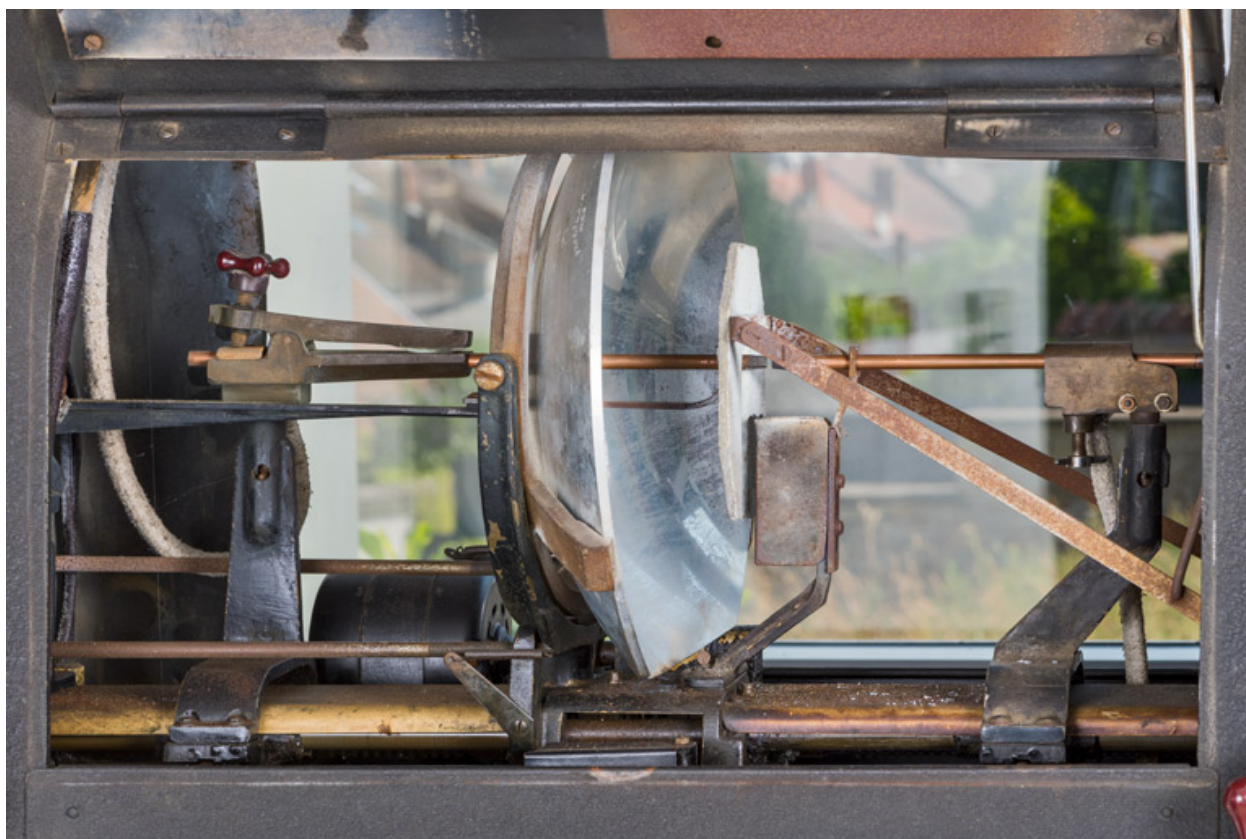
1er projecteur : lanterne ouverte, montrant miroir et électrodes, cache baissé.
