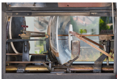
1er projecteur : lanterne ouverte, montrant miroir et électrodes, cache baissé. Phot. Pierre-Marie Barbe-Richaud IVR26_20257100702NUC4A
