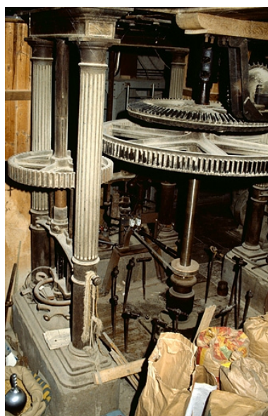
Beffroi : transmission et commandes d'admission d'eau de la turbine. Phot. Laurent Poupard IVR43_19883900657ZA
