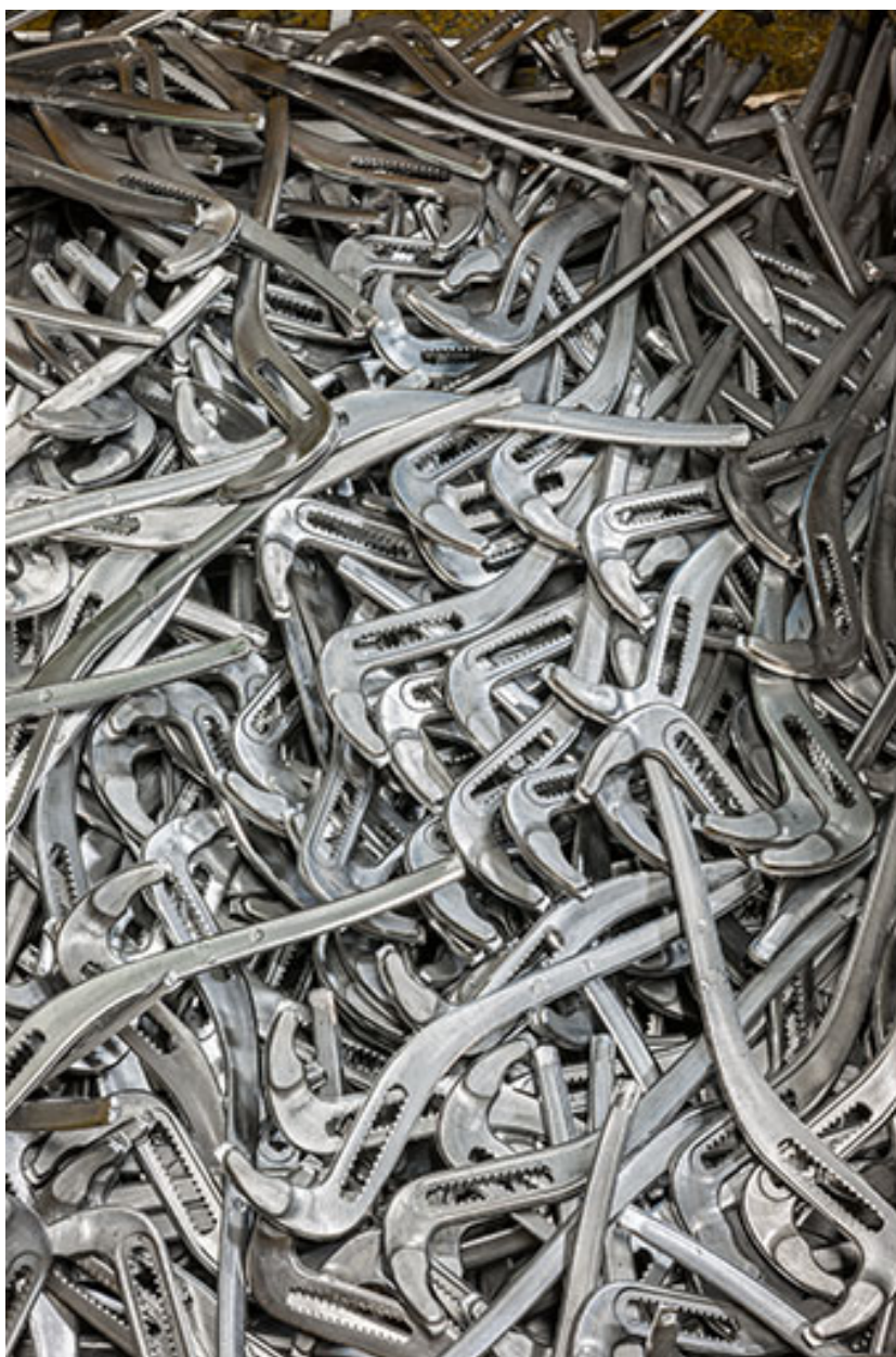
Branches de pinces multiprises (usine d'outillage Bost Garnache Industries, Laissey).
