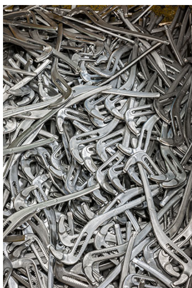
Branches de pinces multiprises (usine d'outillage Bost Garnache Industries, Laissey). Phot. Jérôme Mongreville IVR43_20142501625NUC4A
