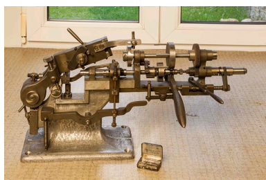
Machine à fabriquer les tire-nerfs pour dentiste (atelier de construction mécanique Berçot puis Roch, Maîche). Phot. Yves Sancey IVR43_20132501941NUC2A
