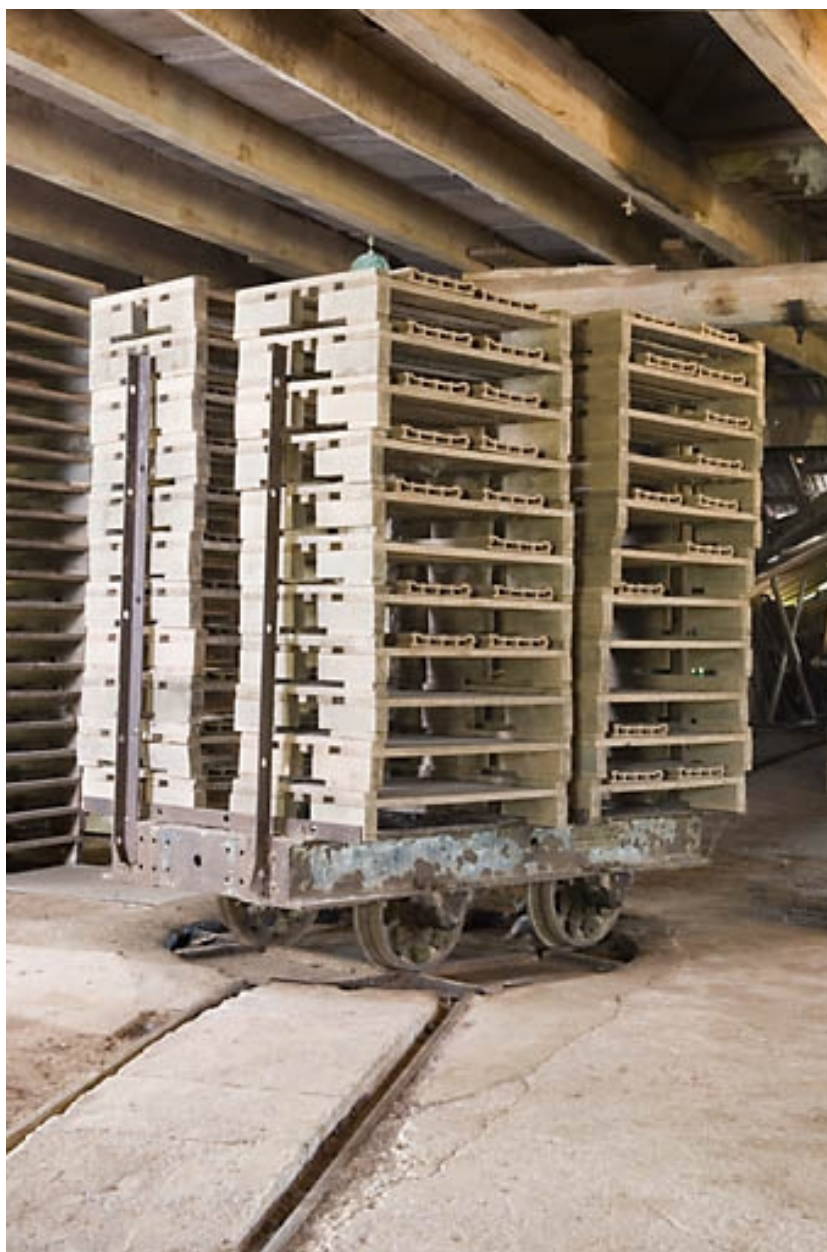
Wagonnet à plateaux sur plaque tournante.
