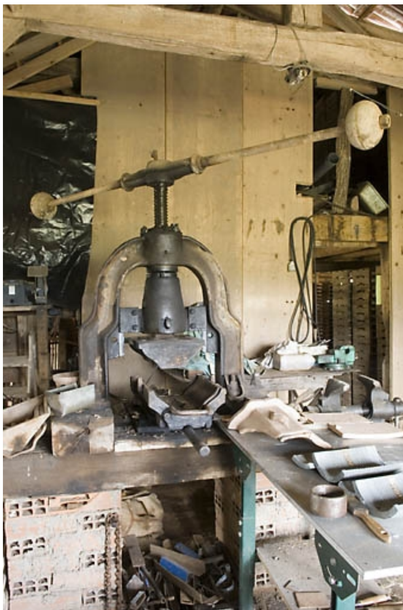
Presse à balancier (pour tuiles faîtières).
