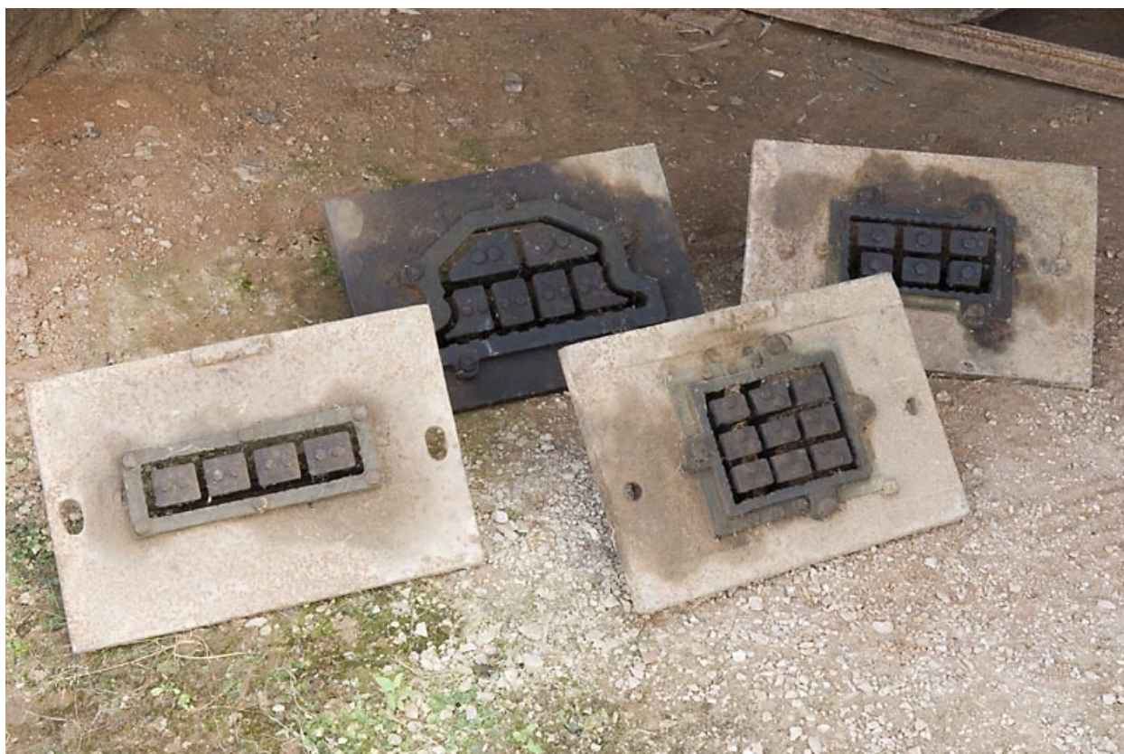
Matrices pour briques de la mouleuse-étireuse.
