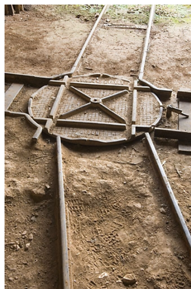
Voie système Decauville. Plaque tournante Pétolat. Phot. Jérôme Mongreville IVR43_20087000786NUC2A
