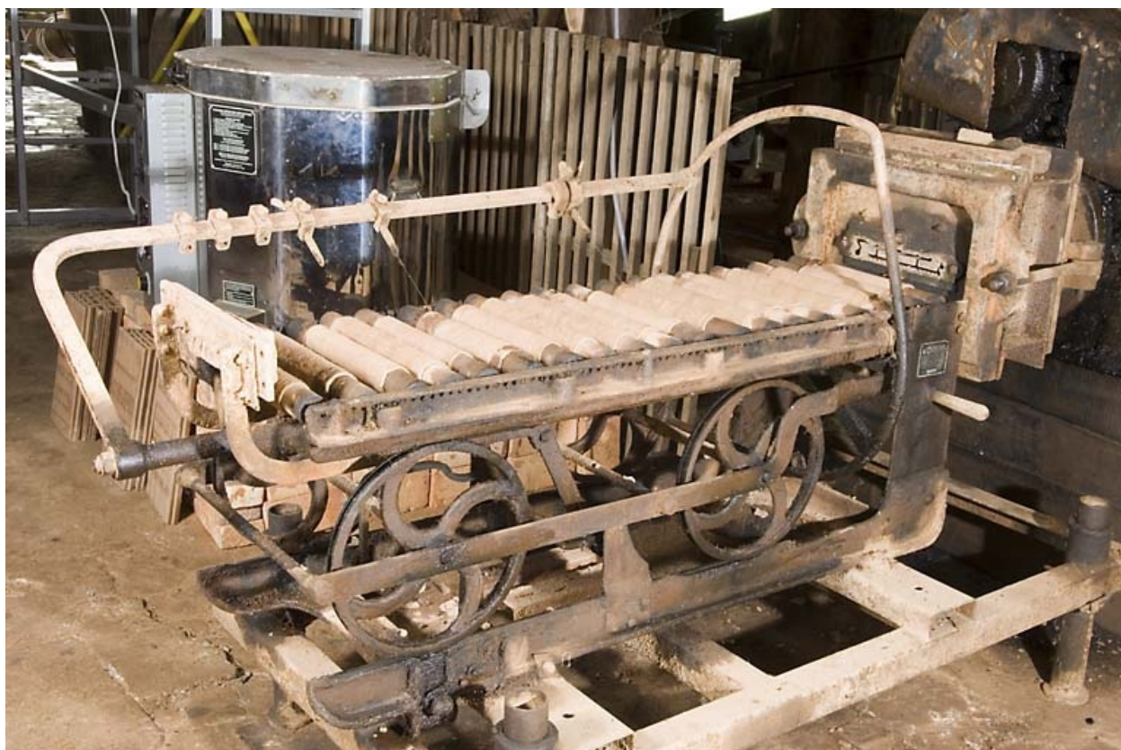
Chariot découpeur de la mouleuse-étireuse.
