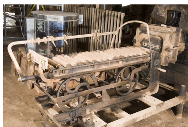
Chariot découpeur de la mouleuse-étireuse. Phot. Jérôme Mongreville IVR43_20087000781NUC2A
