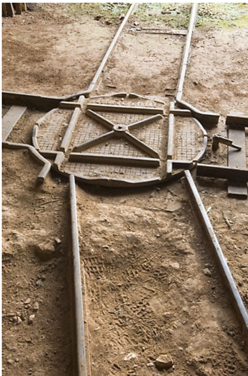
Voie système Decauville. Plaque tournante Pétolet.
