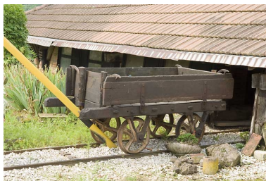
Wagonnet en bois (transport de la terre). Phot. Jérôme Mongreville IVR43_20087000760NUC2A
