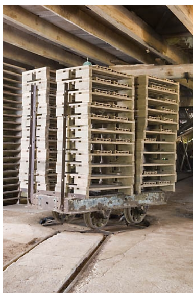
Wagonnet à plateaux sur plaque tournante. Phot. Jérôme Mongreville IVR43_20087000787NUC2A
