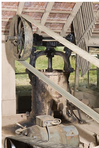
Malaxeur et moteur électrique. Phot. Jérôme Mongreville IVR43_20087000777NUC2A
