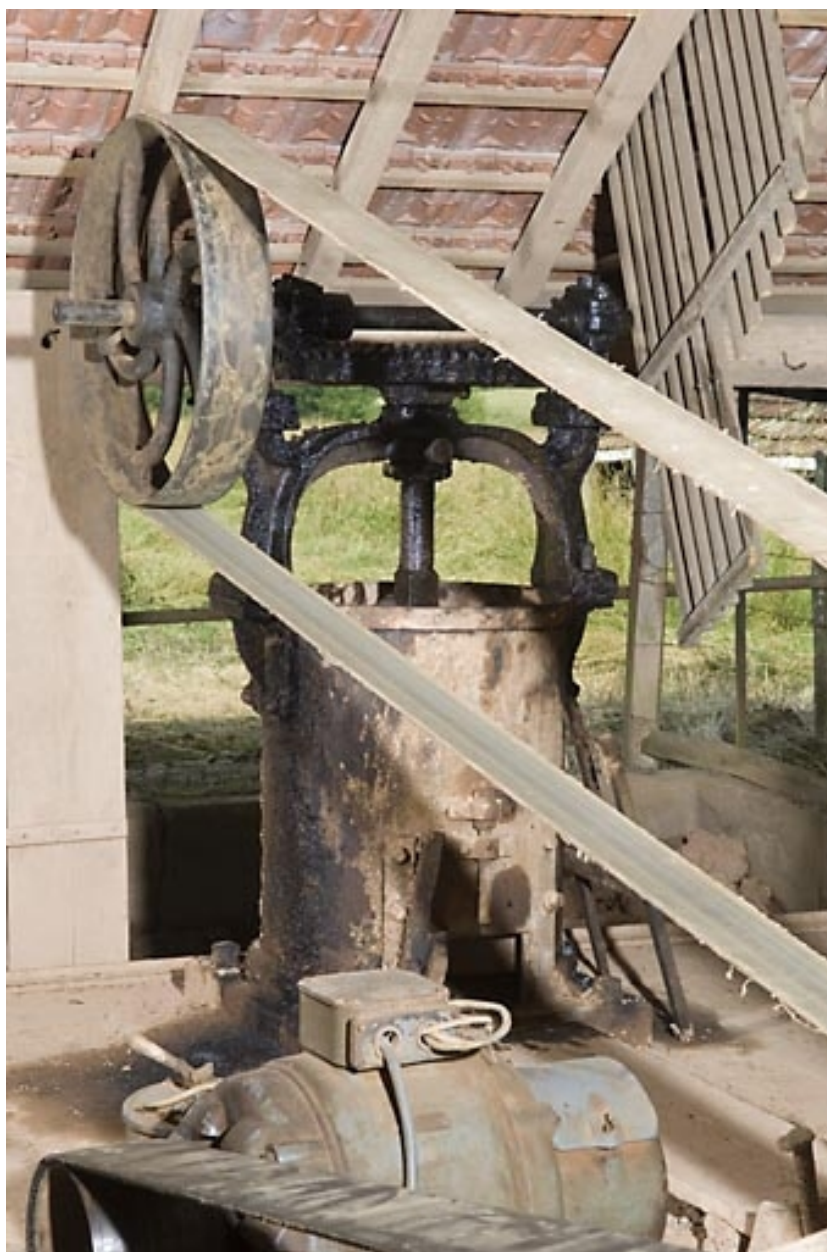
Malaxeur et moteur électrique.
