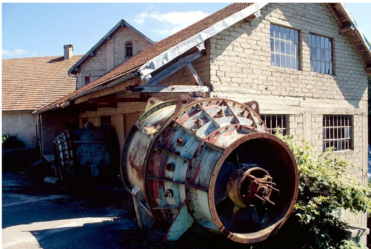
Turbines déposées devant le magasin industriel.
