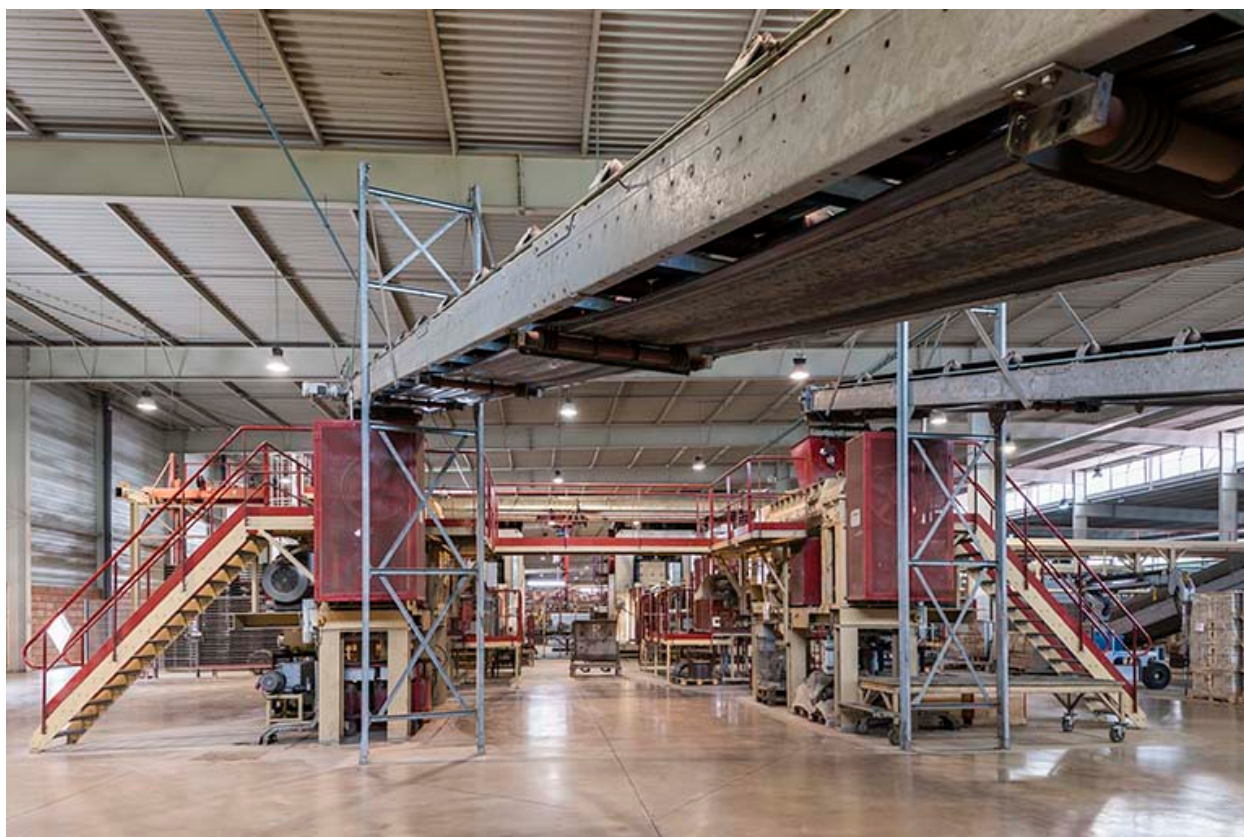
Unité de fabrication dite UL 5. Acheminement de la terre aux deux lignes de pressage par transporteur à bande.
