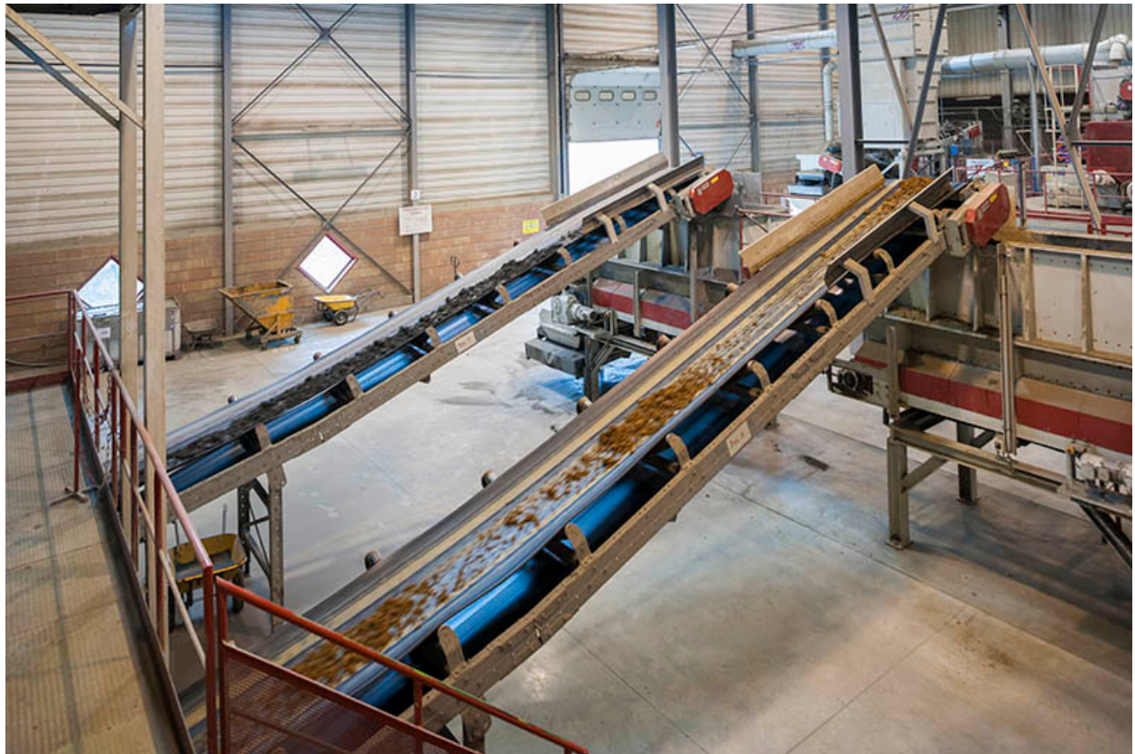
Unité de préparation des terres. Transport depuis le doseur (pesée et brise-mottes) jusqu'au doseurs-tampon.
