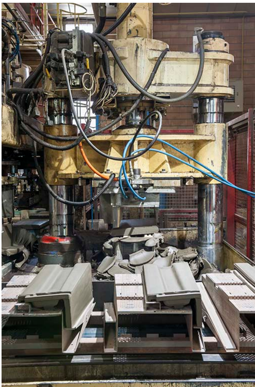
Unité de fabrication dite UL 3. Le pressage.
