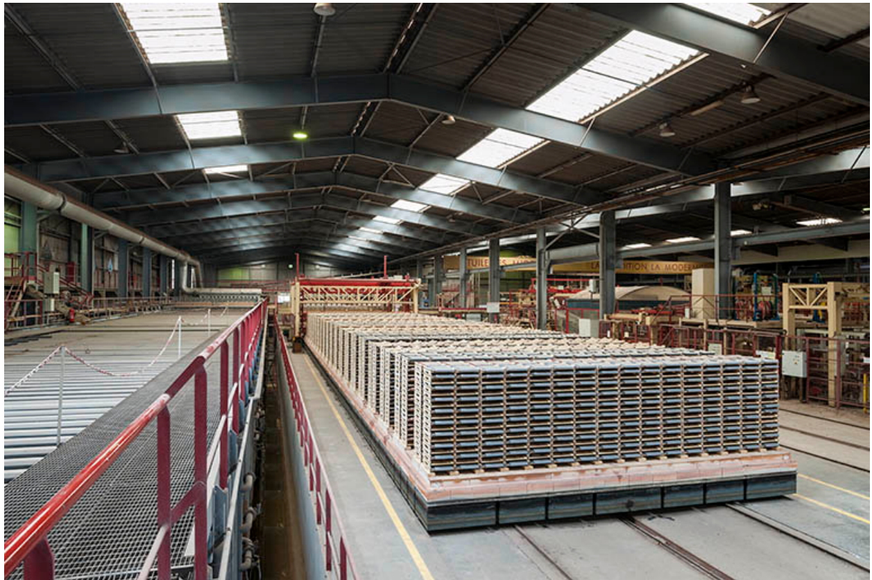
Unité de fabrication dite UL 2 (à l'arrêt). Four piscine (à gauche) et chariot réfractaire (à droite).
