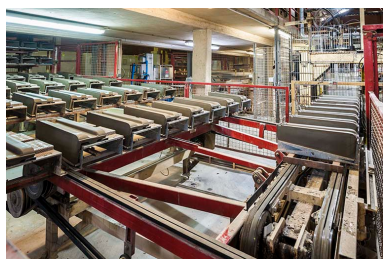
Tuiles en sortie de la mouleuse. Phot. Jérôme Mongreville IVR43_20152501340NUC4A
