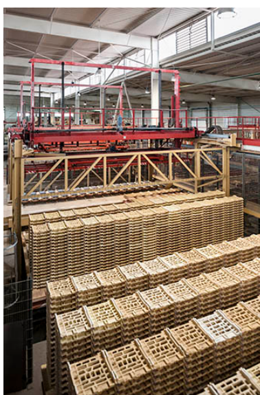
Unité de fabrication dite UL 5. Supports réfractaires pour la cuisson des tuiles. Phot. Jérôme Mongreville IVR43_20152501362NUC4A
