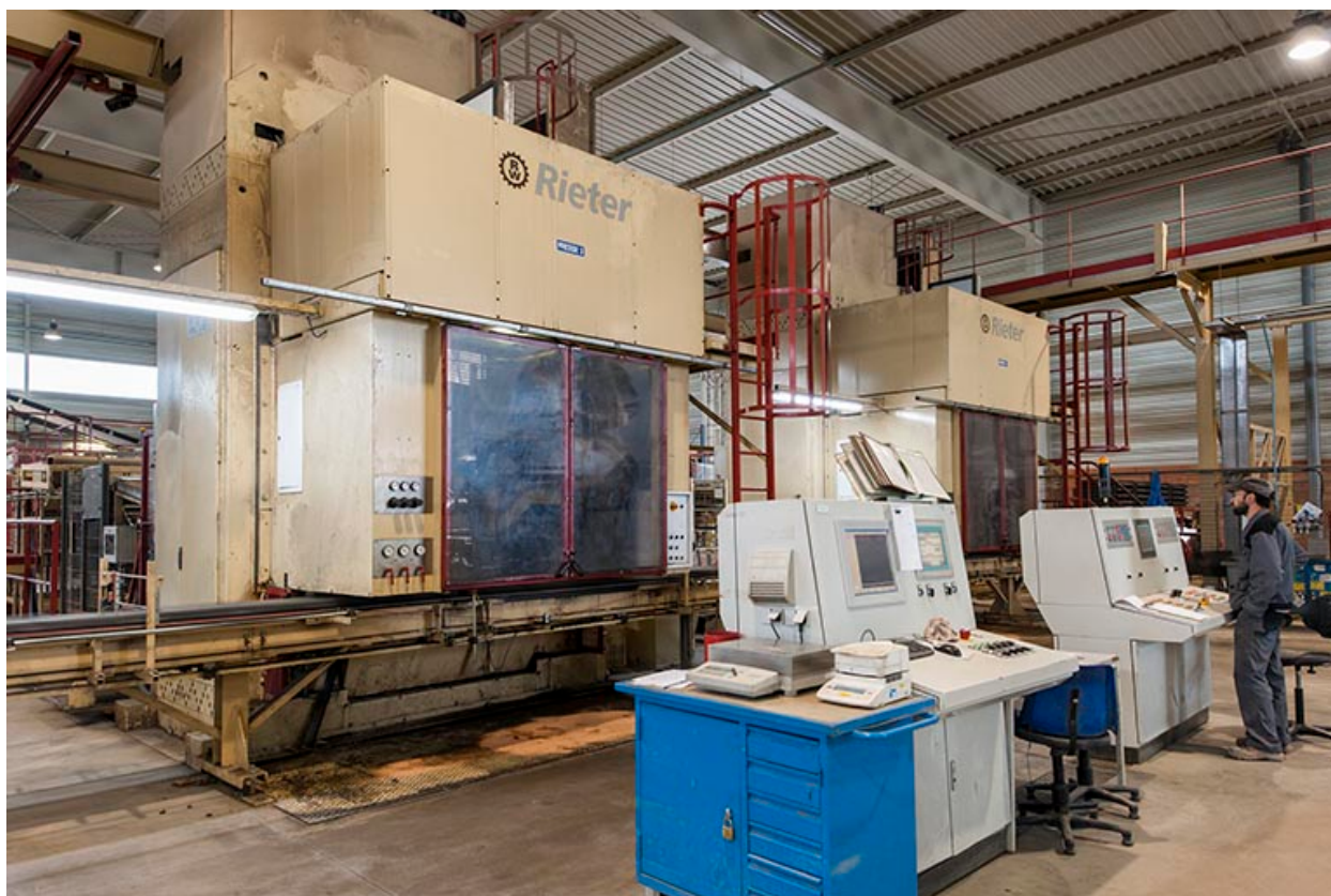
Unité de fabrication dite UL 5. Presses Rieter.
