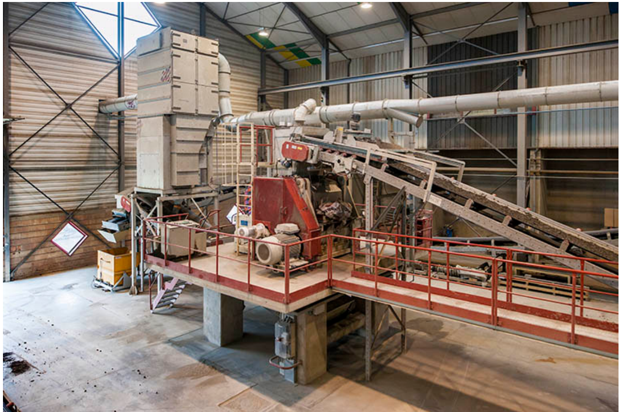
Unité de préparation des terres. Laminoir-finisher.
