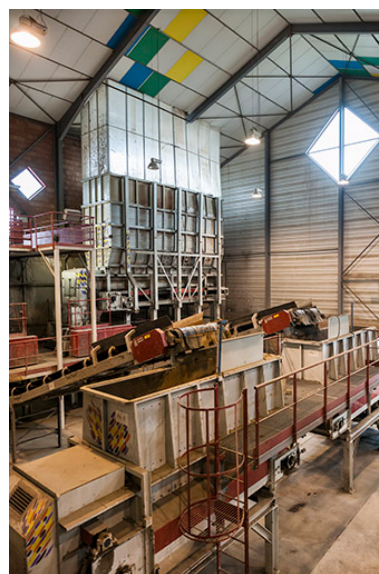
Partie sud de l'unité de préparation des terres. Au premier plan, doseurs- tampon. Au second plan, cellules des doseurs (pesée et brise-mottes). Phot. Jérôme Mongreville IVR43_20152501324NUC4A
