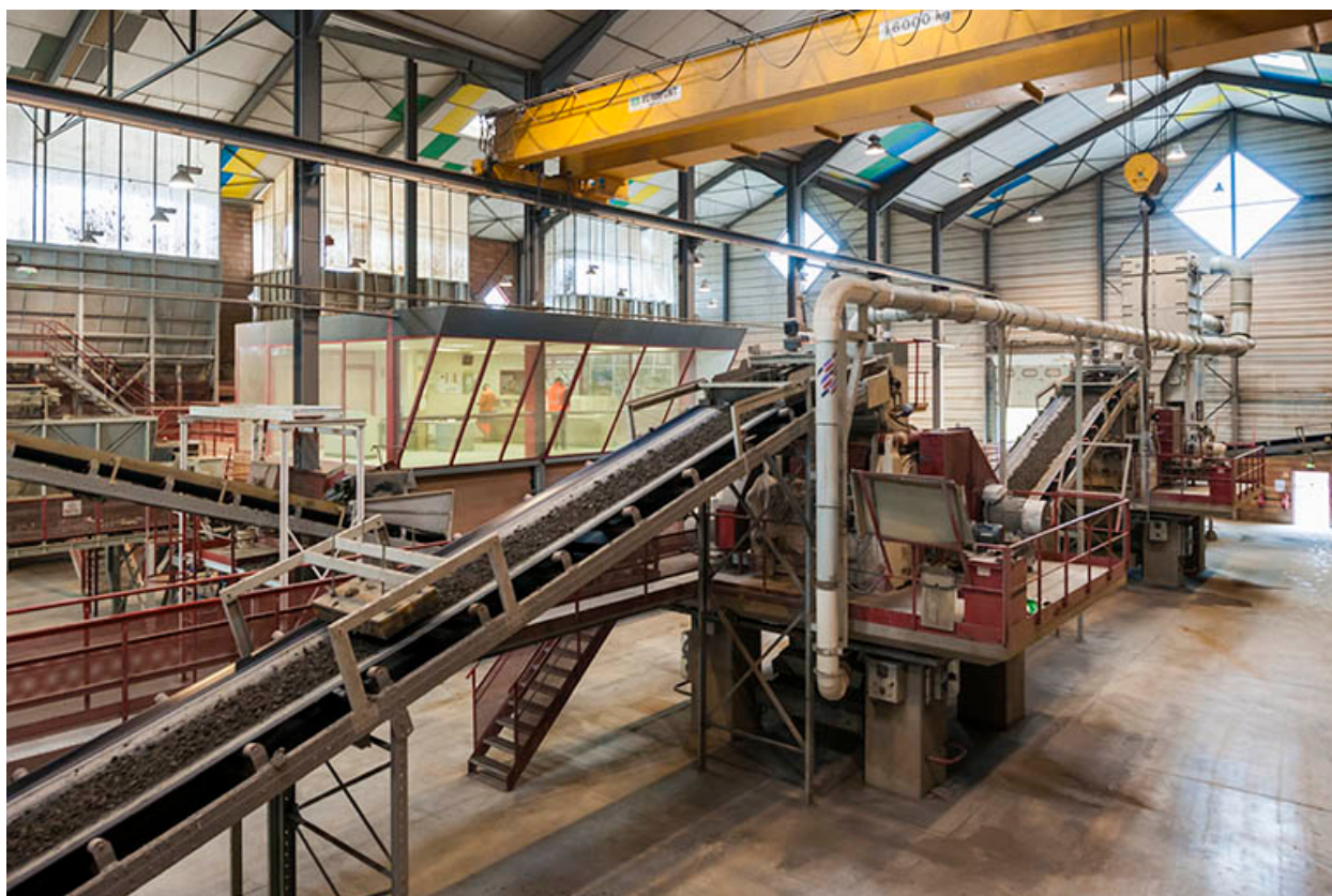
Unité de préparation des terres. De gauche à droite : poste de contrôle, laminoir-dégrossisseur et laminoir-finisseur.
