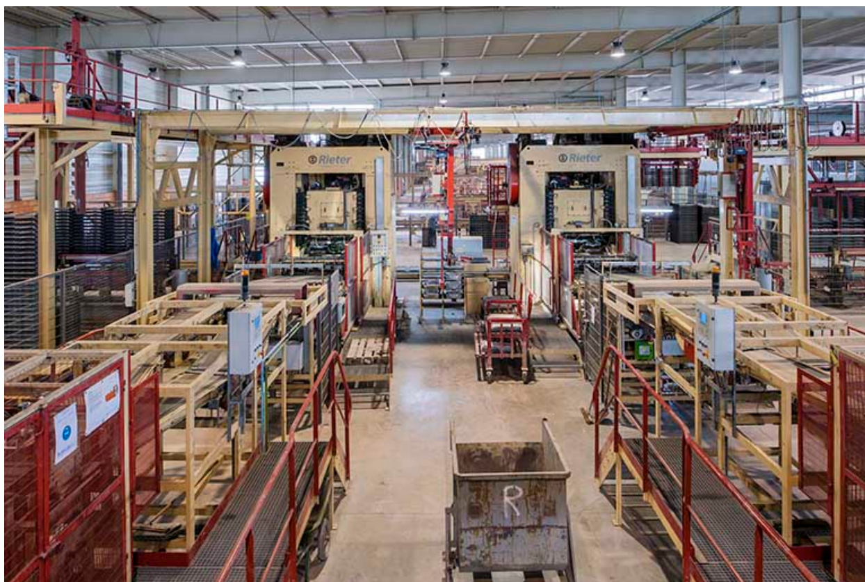
Unité de fabrication dite UL 5. Les deux lignes de moulage-pressage.
