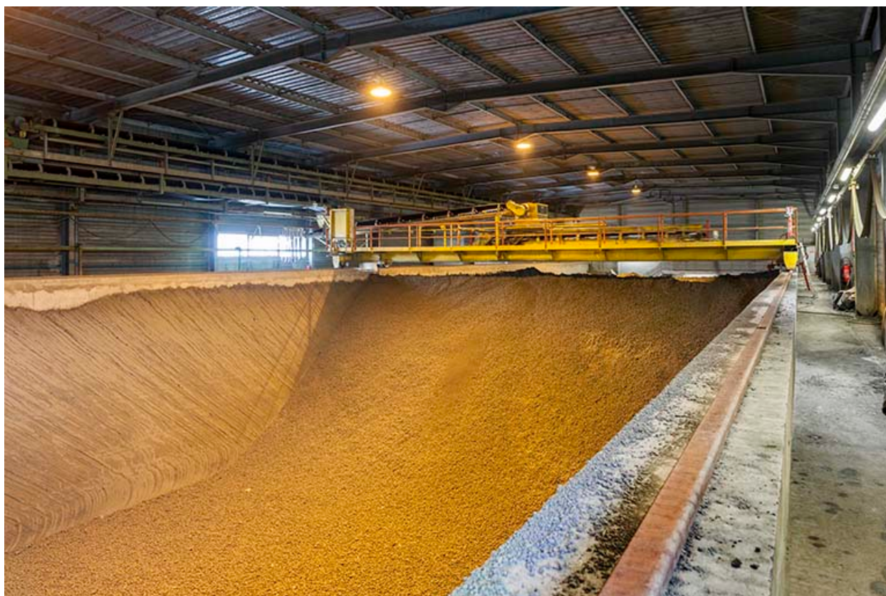
Fosse à terre, et pont jeteur (terre en boulettes).
