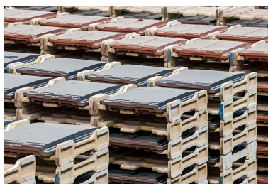
Unité de fabrication dite UL 2 (à l'arrêt). Détail d'un chariot de tuiles, avec supports réfractaires individuels (pour four piscine). Phot. Jérôme Mongreville IVR43_20152501335NUC4A
