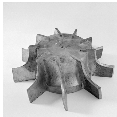
Détail d'une fraise vue de côté. Phot. Jérôme Mongreville IVR43_20022500952X
