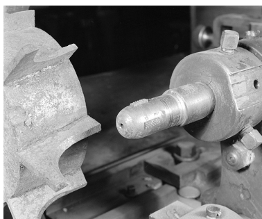
Détail de la fraise et du système de fixation du fourneau par l'intérieur du foyer (arrondisseur de l'atelier principal). Phot. Jérôme Mongreville IVR43_20022500598X
