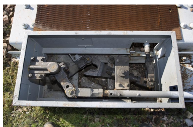
Système de renvoi d'angle. La tringle actionnant les aiguilles (en haut) est reliée à celle du levier de manoeuvre par une pièce métallique dite " pince de homard ". Phot. Yves Sancey IVR43_20073900050NUCA
