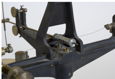
Fil d'acier et extrémité du bras inférieur du parallélogramme déformable. Phot. Yves Sancey IVR43_20072500851NUCA
