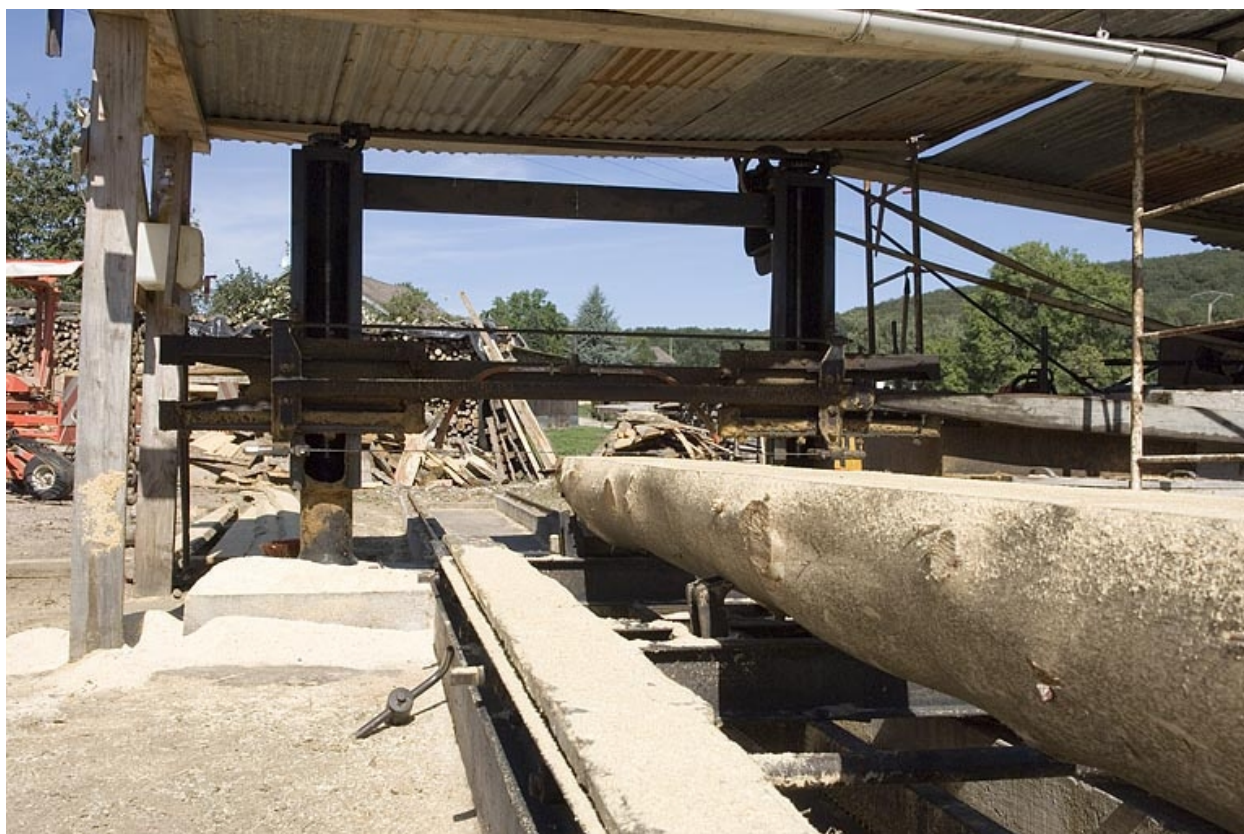
Scie horizontale monolame. Chariot et châssis (hameau de la Louvière).
