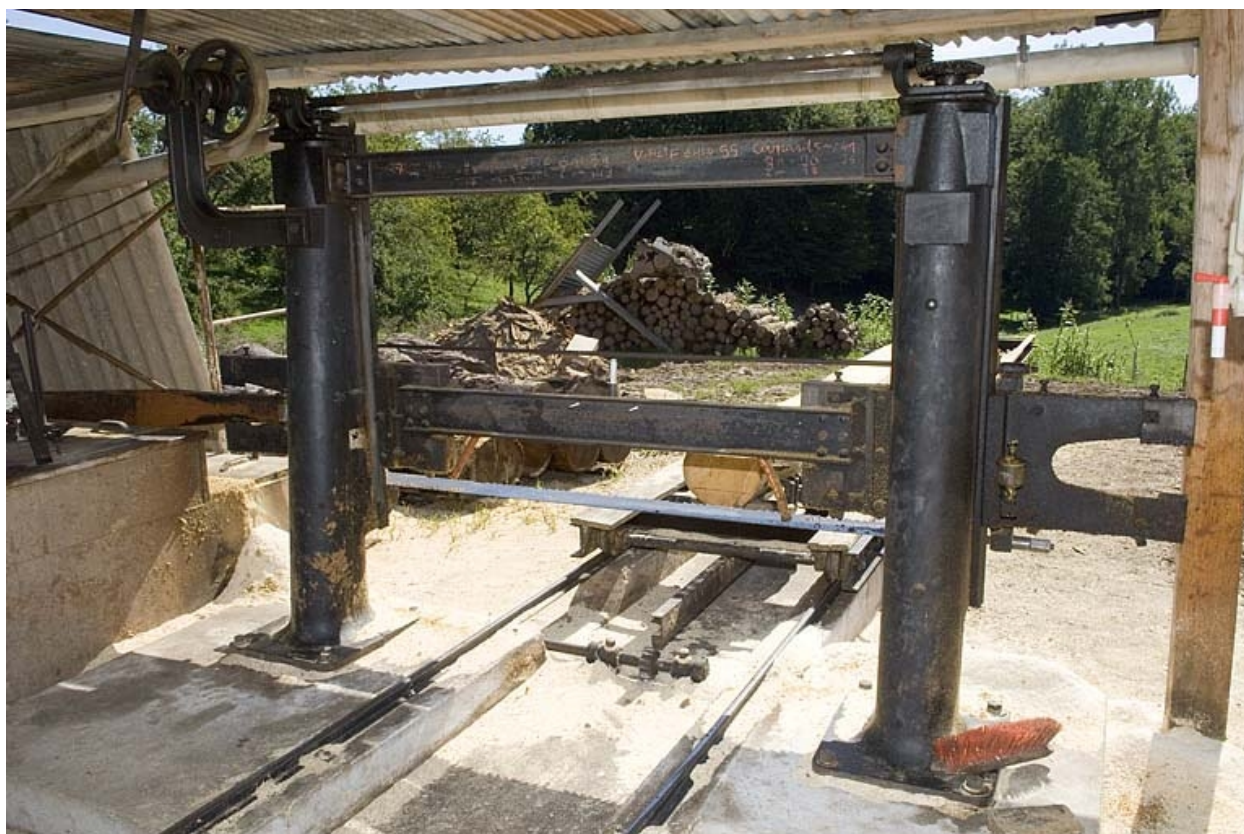
Scie horizontale monolame. Détail du châssis (hameau de la Louvière).
