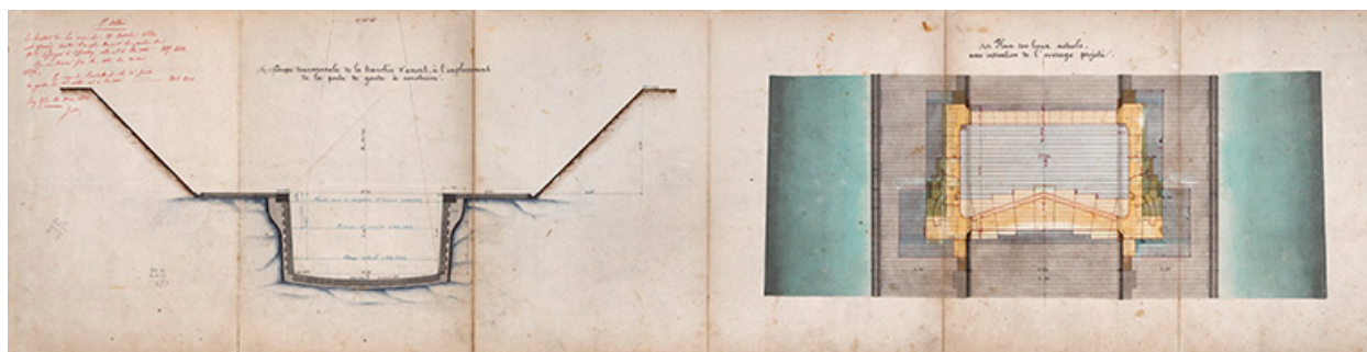
Construction du barrage mobile et de la seconde porte de garde de St-Albin - Seconde porte, élévation, coupes et plans (1876).
